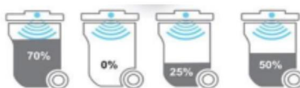
Figura 2.5 Esquema da medição periódica efetuada nos contentores. Fonte:Gkouskos, Zacharias, 2019 [8] .
