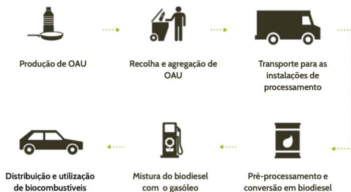
Figura 2.2 Ilustração esquemática da cadeia “de OAU para biodiesel” que se aplica em todos os projetos incluídos na RecOil (Fonte: RecOil, 2015 [16] ).
