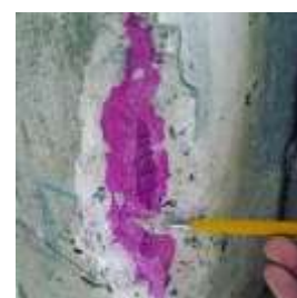
Fig. 2.6 – Ensaio de fenolftaleína [16]
