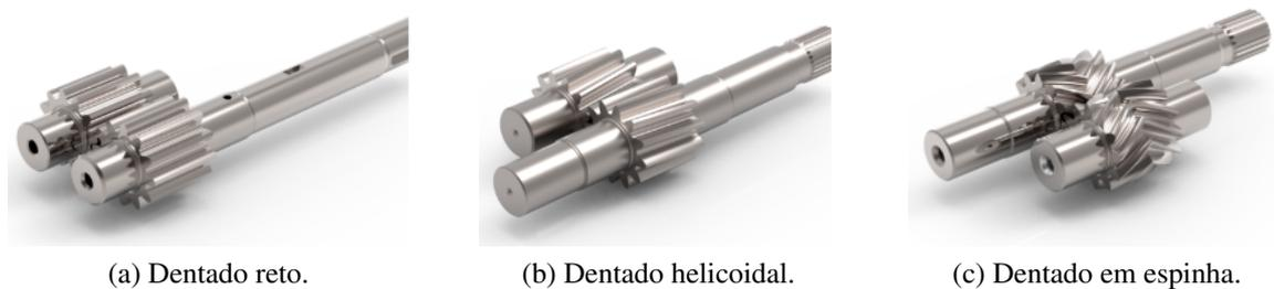
Figura 3.15 - Tipos de dentado das bombas Witte.[25]
