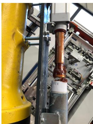
Figura 6.15 - Escape da massa consistente pelas paredes do tubo.
