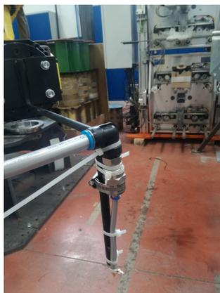
Figura 6.17 - Utilização da tubagem de 16 mm ao longo do trajeto com tubagem de 8 mm no final.
