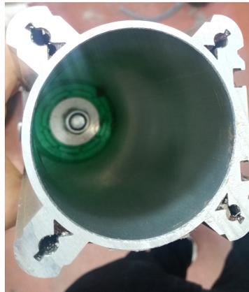
(b) Interior do cilindro após ensaio executado.
