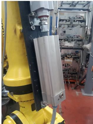
(a) Adaptação do cilindro pneumático.
