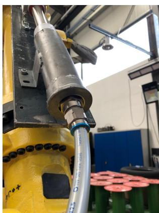
Figura 6.16 - Resultado do alargamento efetuado ao tubo.
