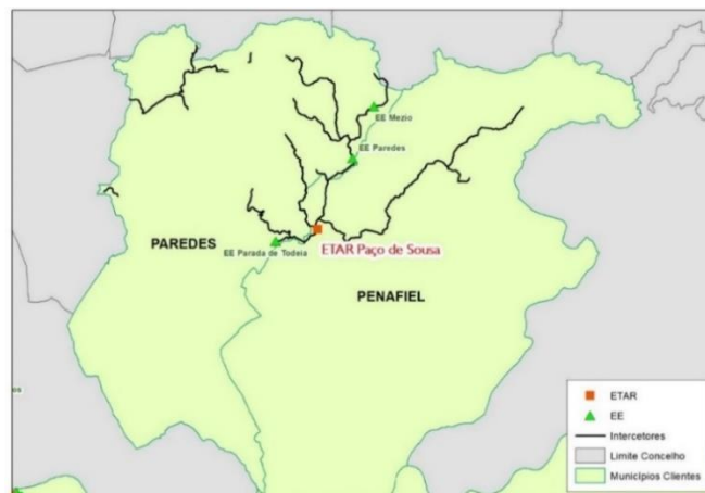
Figura 7 - Sistema de Paredes/Penafiel
