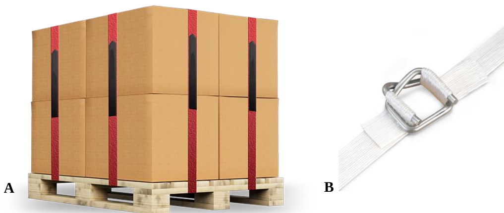
Figura 2-9: Aplicação do método das cintas: em paleta (A) [37] peça utilizada para ajuste de tensão da cinta (B) [38].
