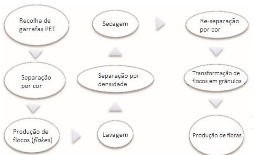
Figura 4-1: Processo de reciclagem de garrafas PET em fibra de poliéster (adaptado de: Esin Sarioğlu et al [48])
