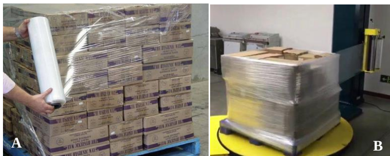
Figura 2-3: Aplicação do filme extensível plástico: (A) manual [19]; (B) automática [20].
