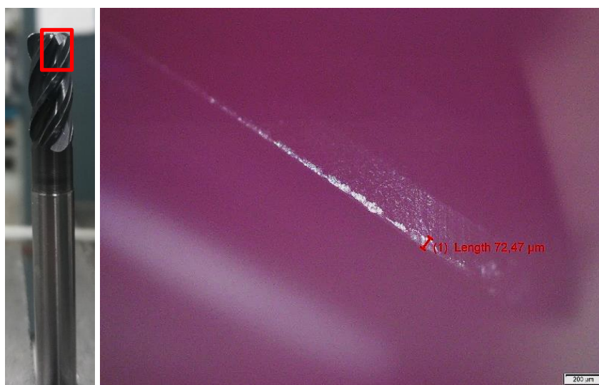
Figura 52 - Fresa monobloco analisada após utilização (ferramenta nº 17). À esquerda: fotografia da ferramenta; à direita: observação microscópica da lâmina (desgaste na aresta de corte: 72,47µm).
