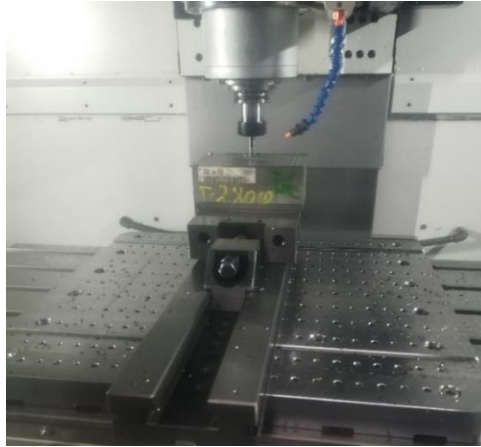
Figura 34 - Exemplo da disposição do teste para verificação de vida das ferramentas (teste nº 1 com a ferramenta nº14).
