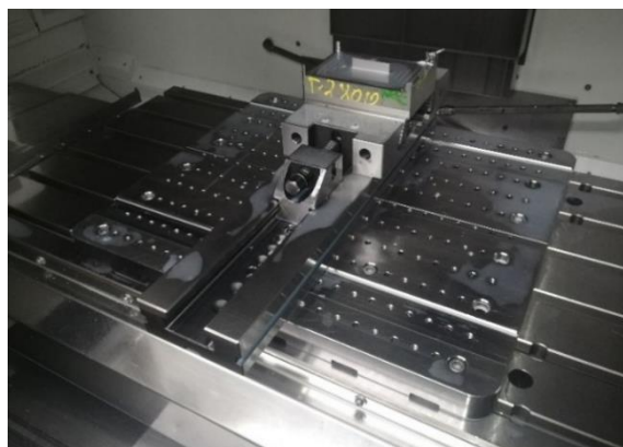
Figura 26 - Placa multi-furo presente na CNC3, com prensa de aperto acoplada.
