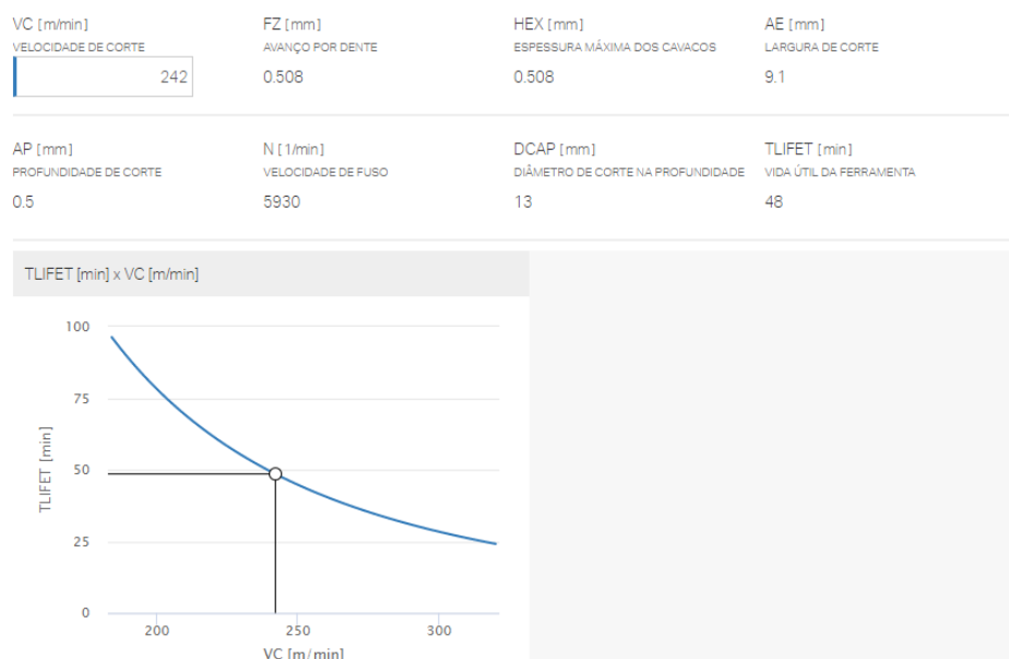
Figura 31 - Exemplo de apresentação de um gráfico T-V c fornecido pela calculadora da velocidade de corte [25].
