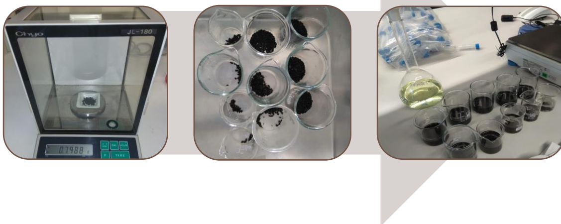
Figura 21 - Preparação para ensaio de isotérmica de adsorção.
