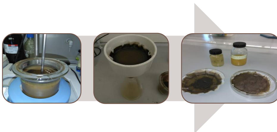
Figura 20 -Filtração da polpa de lixiviação com tiosulfato de sódio e soluções resultantes.
