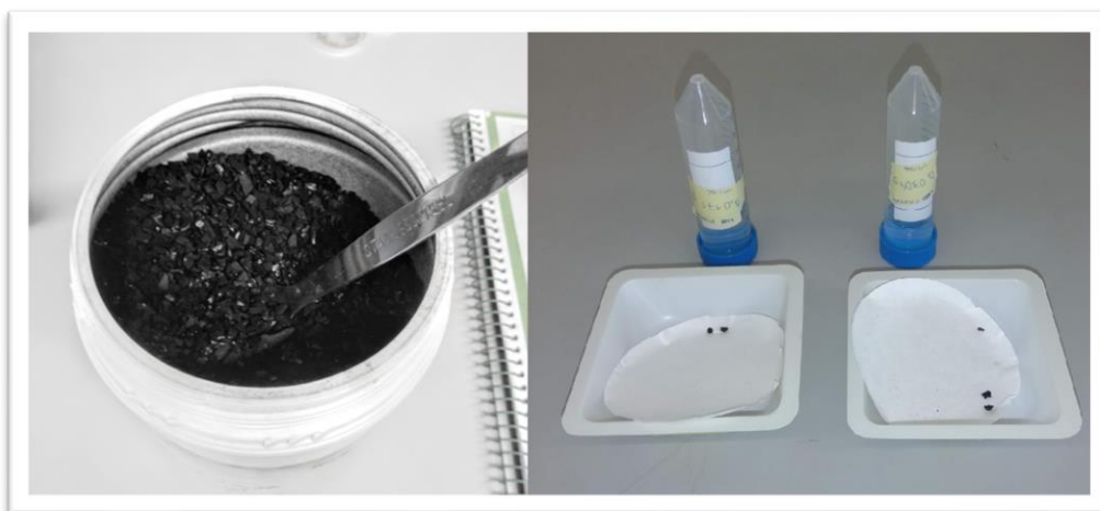
Figura 29 – Partículas de carvão ativado e quantidade utilizada nos ensaios isotérmicos.
