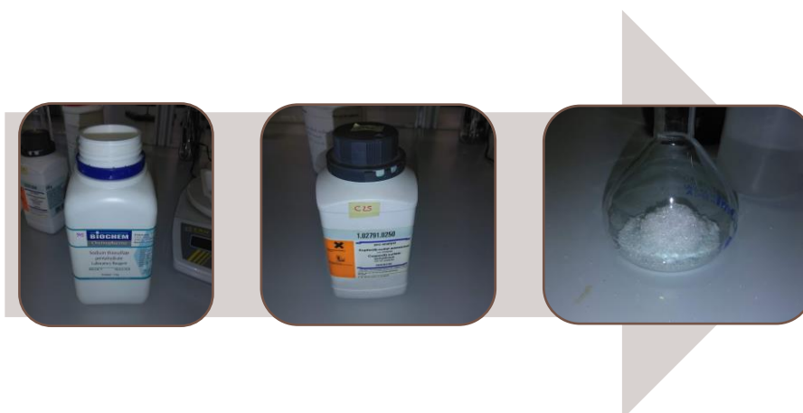
Figura 19 – Reagentes sólidos utilizados (tiosulfato de sódio pentahidratado e sulfato de cobre) no balão volumétrico.
