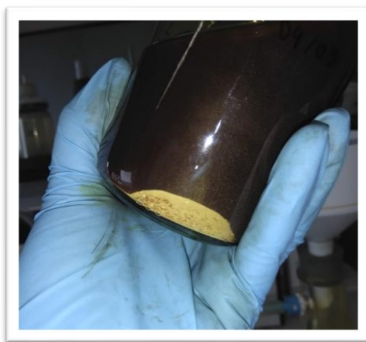
Figura 26 - Depósito encontrado nos lixiviados com bromo.
