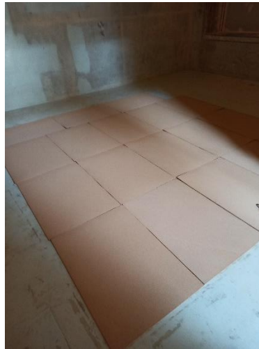
Figura 4.4 – Disposição das placas no piso da câmara reverberante para o ensaio.[Foto do autor]
