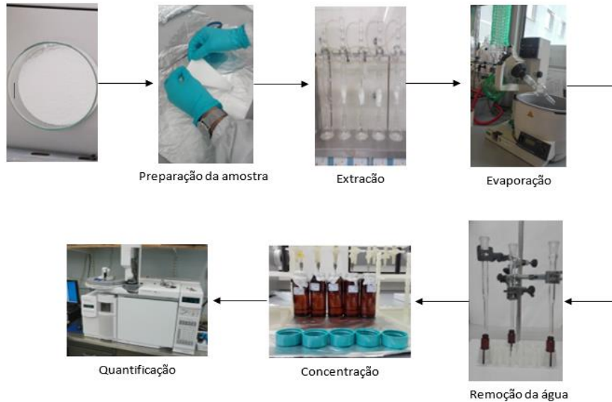
Figura 4 – Esquema do procedimento experimental para a extração de VMS de sorbente XAD-2 através do método de Soxhlet.
