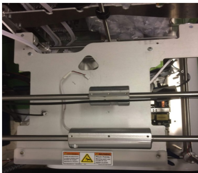
Figura 4.2: CubePro sem o suporte do motor, apenas a carruagem foi mantida.
