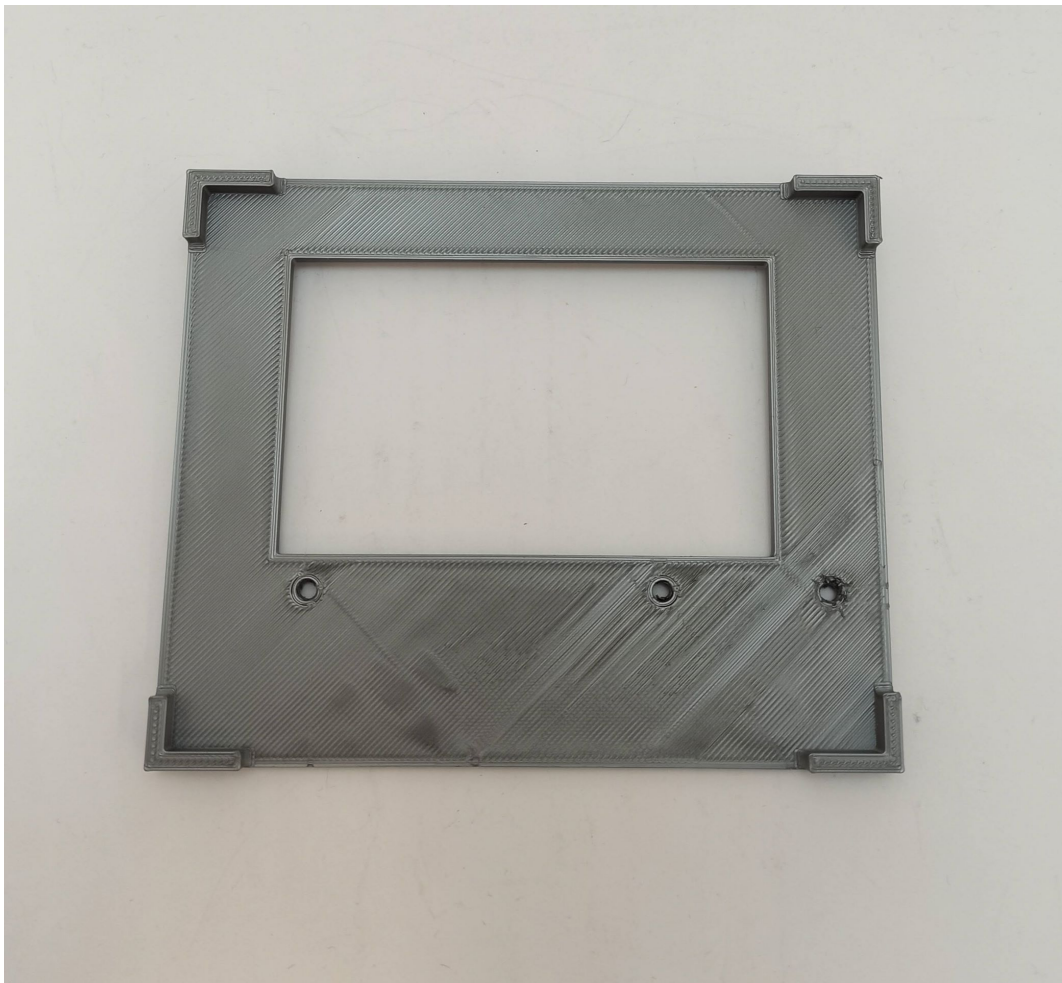
Figura A.9: Primeiro protótipo do suporte da Duet .
