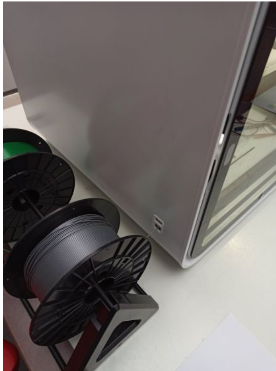
Figura 4.13: Novo sistema de alimentação de filamento.
