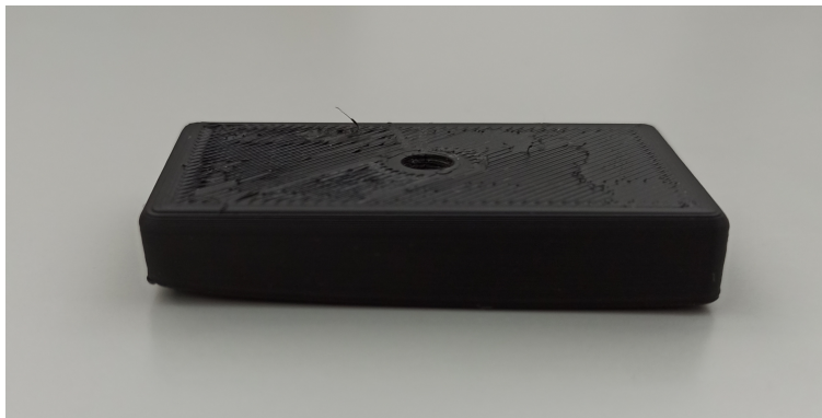
Figura 2.11: Retração térmica numa peça impressa em ABS.
