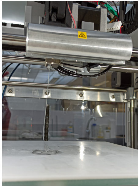
Figura 4.23: Teste da alimentação do filamento com um bico de 0.4mm.
