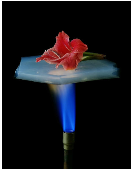
Figura 38: Demonstração do nível de isolamento térmico do aerogel de sílica [36].
