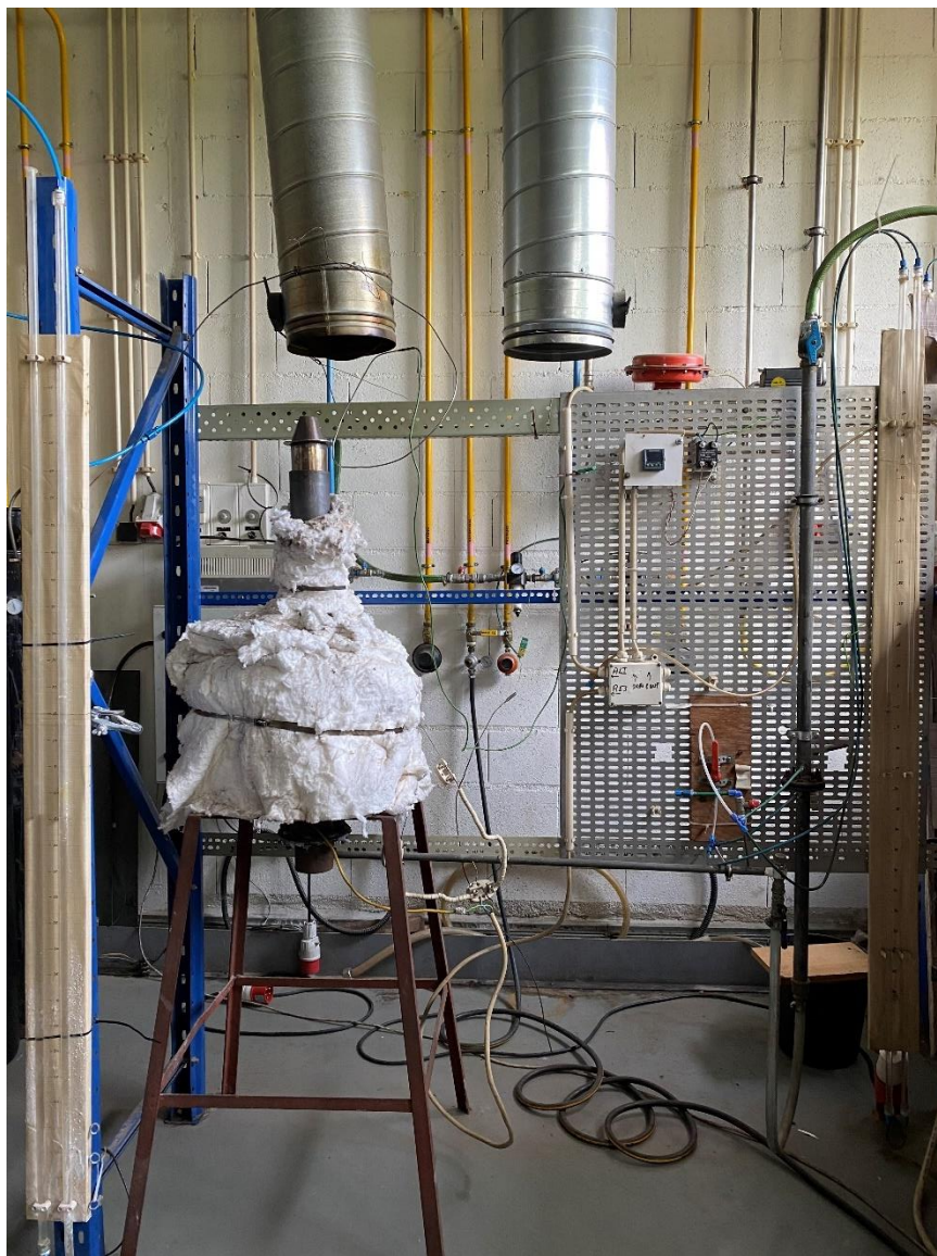
Figura 6.1 - Instalação de queima em leito fluidizado usada no presente estudo.
