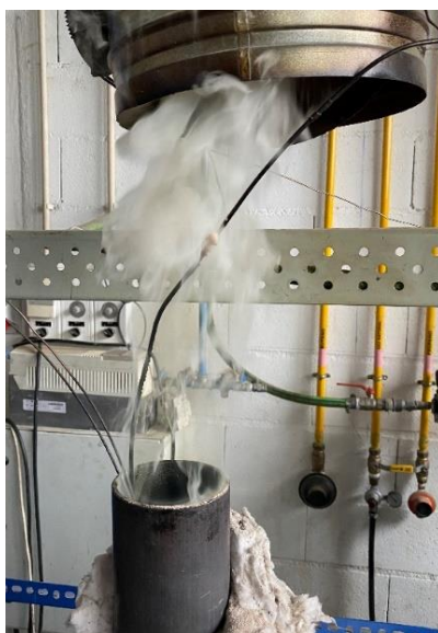
Figura 7.5 - Libertação de voláteis durante a pirólise.
