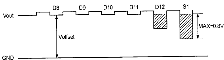
Figura 6.5 Níveis de tensão de saída do CCD
