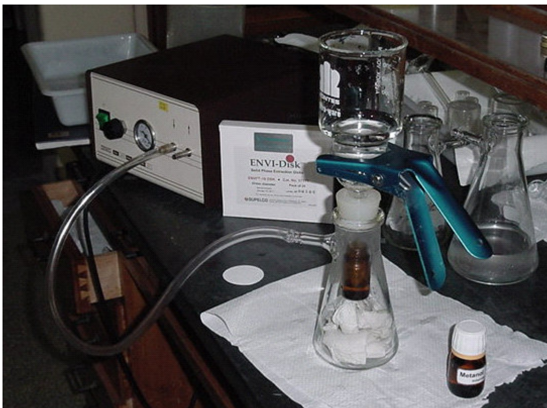
Figura 3.2 Fotografia do sistema de filtração utilizado com os discos C18.
