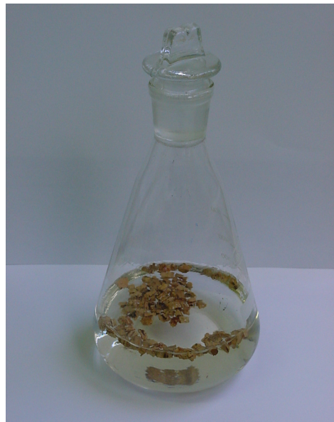
Figura 3.3 Fotografia do adsorvedor fechado utilizado nos ensaios de sorção.
