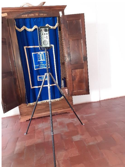
Fig. 5.7 – Fonte sonora e recetor utilizados na medição do RASTI , na Sinagoga de Tomar [fotos da autora].
