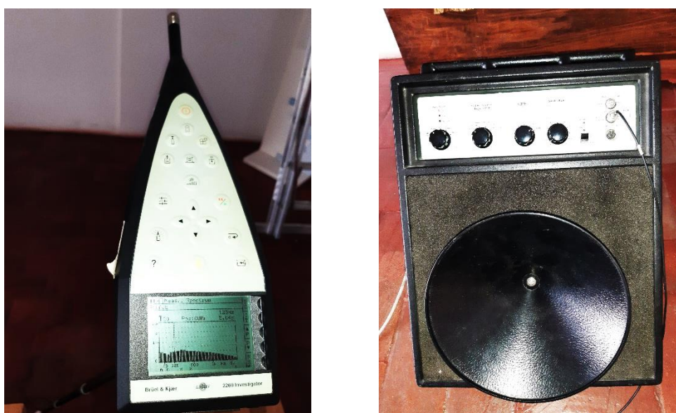
Fig. 5.4 – Sonómetro e fonte sonora utilizados na medição do TR , na Sinagoga de Tomar [fotos da autora].
