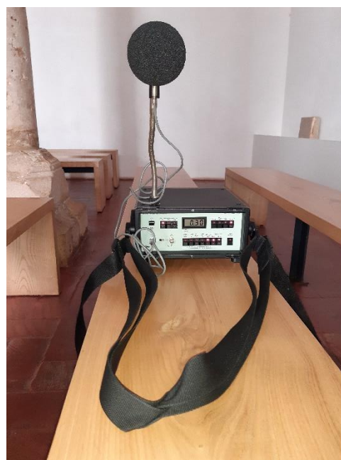
Fig. 5.7 – Fonte sonora e recetor utilizados na medição do RASTI , na Sinagoga de Tomar [fotos da autora].
