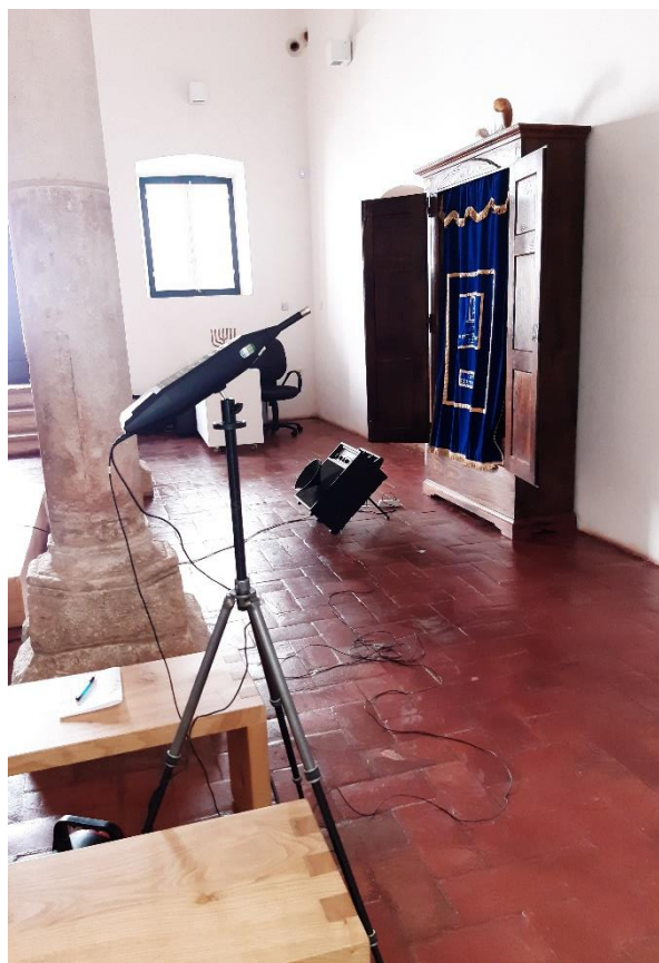
Fig. 5.2 – Colocação da fonte sonora e do microfone (sonómetro) na sinagoga de Tomar para a realização das medições do TR [foto da autora].
