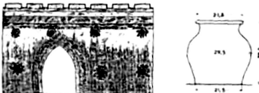
Fig. A1.4 – Imagem exemplificativa das características dos vasos acústicos e da sua localização na igreja dominicana de Zurich (Suíça) [14].
