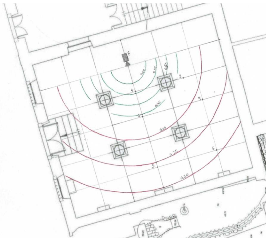
Fig. 5.26 – Linhas de igual valor de RASTI , na sala de culto da Sinagoga de Tomar (a verde as linhas com inteligibilidade acima de suficiente e a vermelho as linhas com inteligibilidade mediocre ).
