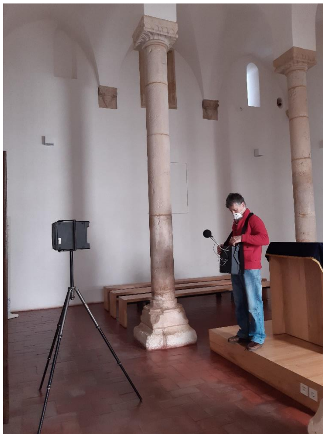
Fig. 5.6 – Colocação da fonte sonora e do recetor (transportado pelo engenheiro do LAFEUP ) na sinagoga de Tomar para a realização das medições do RASTI [foto da autora].
