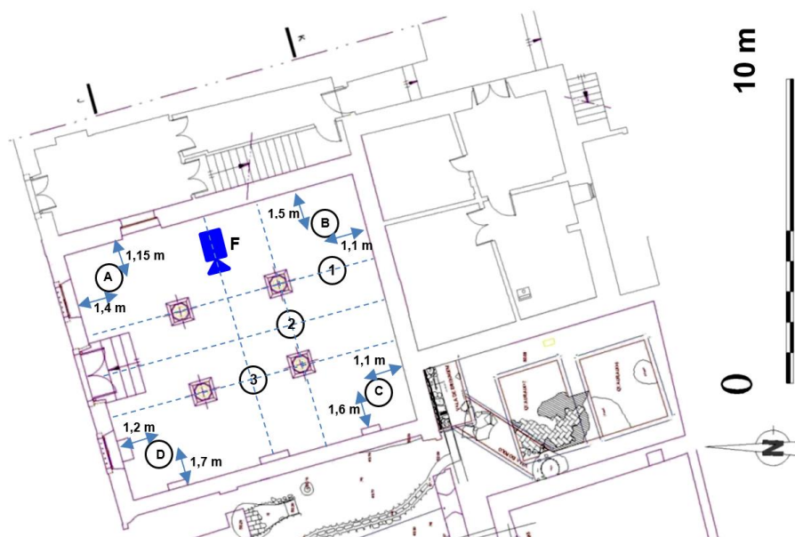
Fig. 5.1 – Localização da fonte sonora (F) e das diferentes posições do microfone (sonómetro) na sala de culto da Sinagoga de Tomar, para o registo dos valores do TR (A, B, C e D representam os pontos de leitura próximos dos cantos e os pontos 1, 2 e 3 representam os pontos de leitura no centro da sala).
