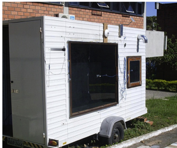
Figura 18 - Calorímetro usado para o método experimental [42]
