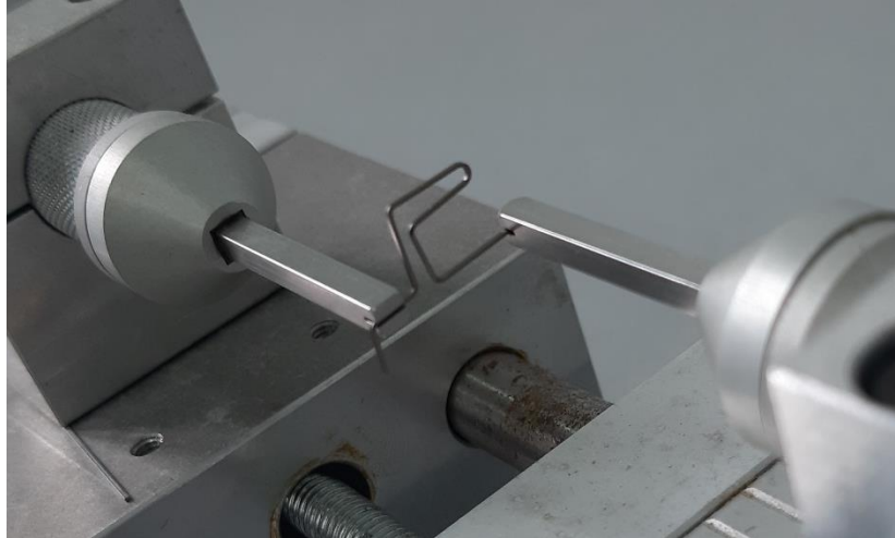
Figura 10 Mola em L inserida nos sulcos das barras metálicas das peças de mão
