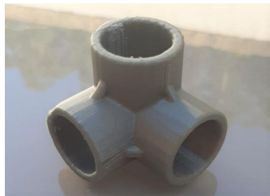
Figura 83 - Resultado da Impressão 3D do tê a 90°
