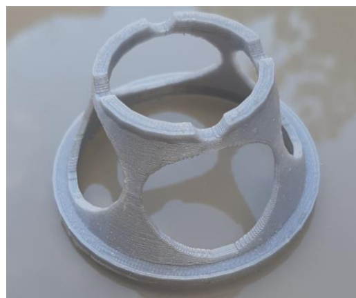
Figura 75 - Resultado da Impressão 3D do espaçador 2 (cruzamento)
