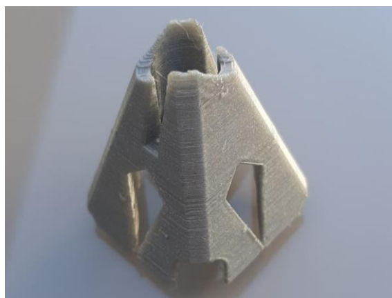
Figura 74 - Resultado da Impressão 3D do espaçador 1 (cavelete)
