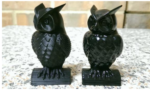
Figura 17 – Modelo impresso antes e depois do pós processamento [31]
