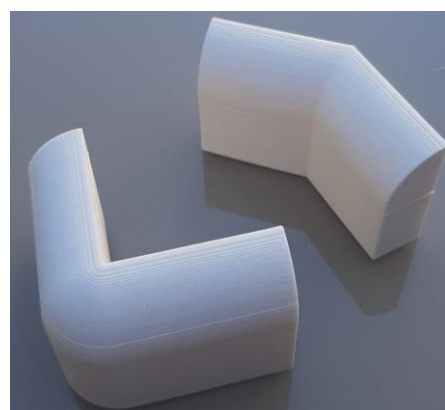
Figura 96 - Resultado da Impressão 3D dos rodapés em ABS
