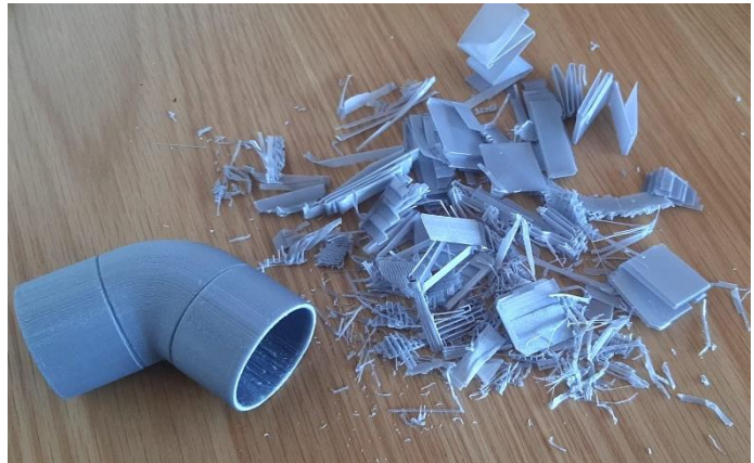
Figura 100 – Curva a 45° após terem sido retiradas as estruturas de suporte
