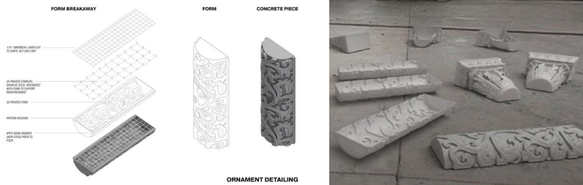
Figura 29 - Processo de moldagem e diferentes peças de betão moldadas [52]
