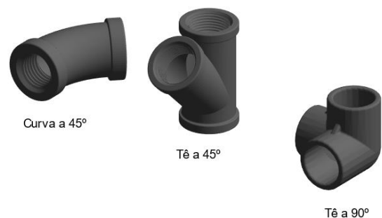
Figura 59- Modelos CAD 3D dos acessórios de instalações hidráulicas adquiridas
