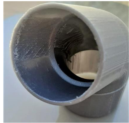
Figura 79 - Resultado da Impressão 3D da curva a 45°, com muitas irregularidades
