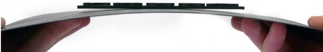
Figura 69 - Forma correta de remover as peças impressas da placa de aço removível [69]
