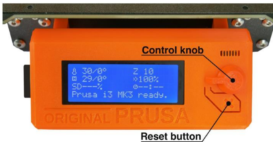
Figura 68 – Ecrã LCD de controlo da impressora 3D [69]
