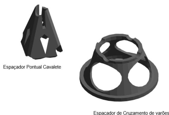
Figura 58 - Modelos CAD 3D de espaçadores de cofragens para armaduras horizontais
