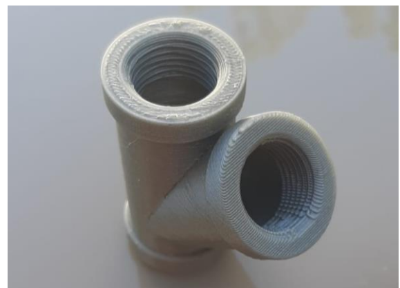
Figura 81 - Resultado da Impressão 3D do tê a 45°
