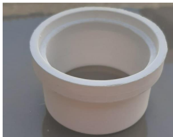
Figura 87 - Resultado da Impressão 3D da junta de união demasiado pequena
