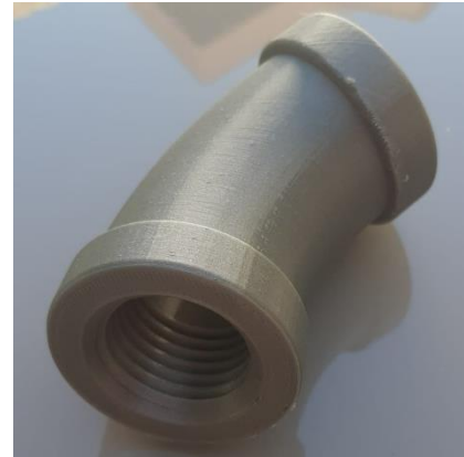
Figura 85 - Resultado da Impressão 3D da curva a 45° roscada
