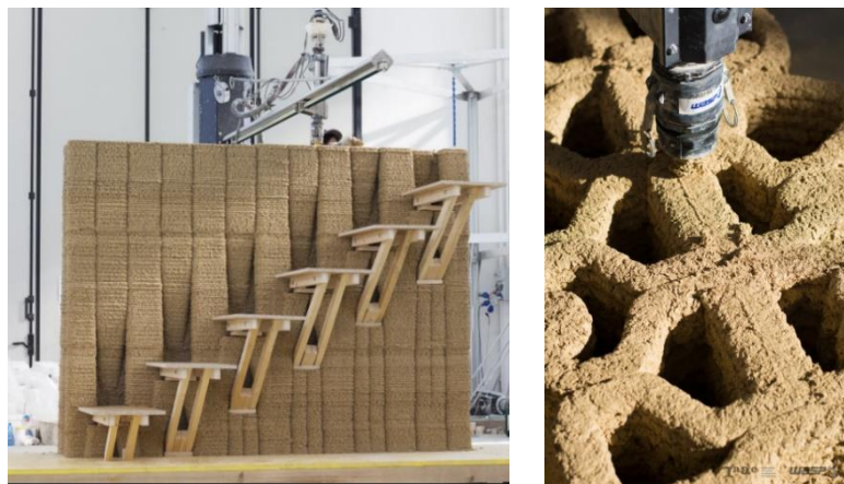
Figura 25 - Parede à base de terra impressa com escadas de madeira embutidas e respetivo padrão de impressão [46]
