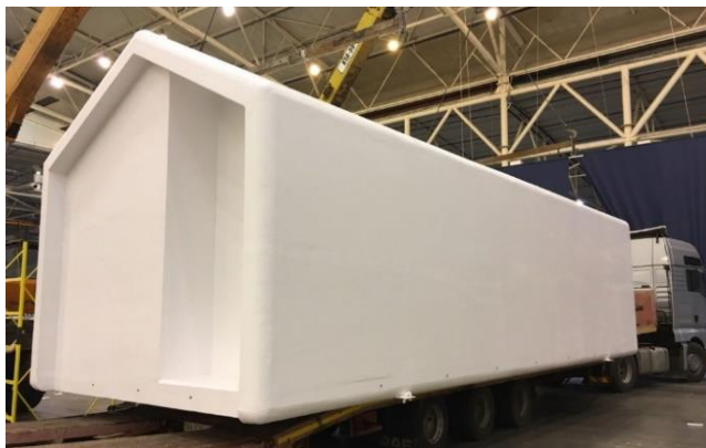
Figura 32 - Módulo pré-fabricado e impresso da Haus pronto para entrega [54]
