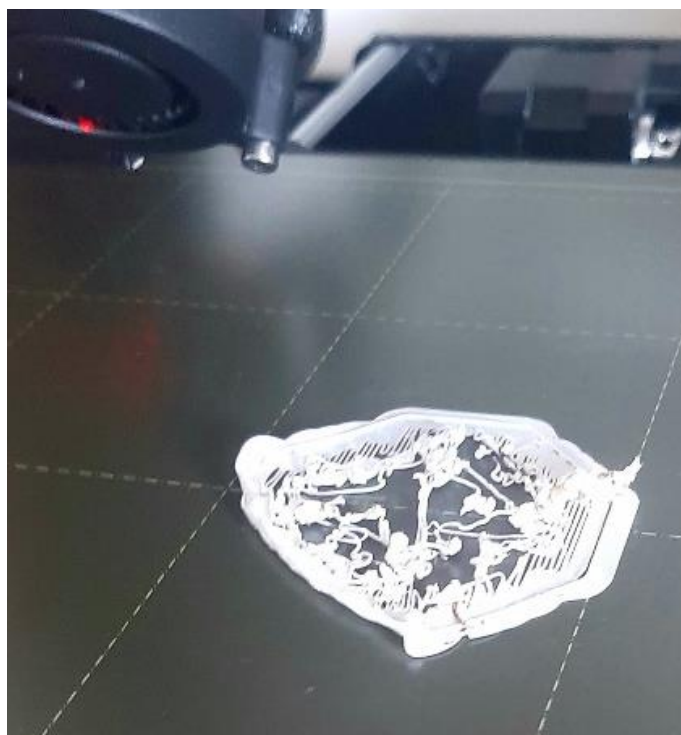
Figura 102 – Efeito de contração das primeiras camadas depositadas com ABS
