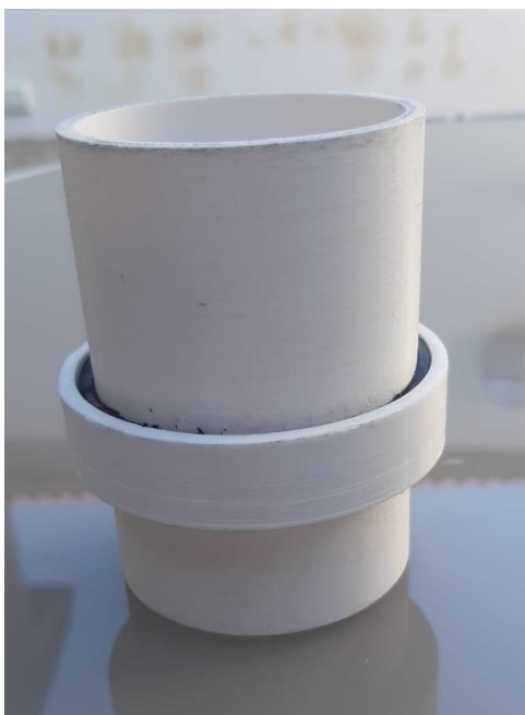
Figura 97 – Peças impressas da junta de união e tubo perfeitamente encaixadas e seladas
