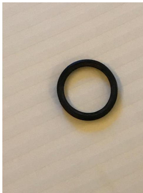
Figura 98 – Anel de borracha utilizado para selar a junção das duas peças
