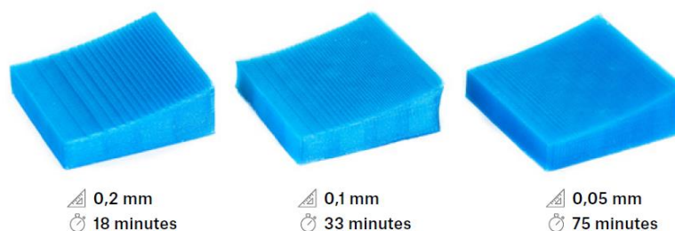
Figura 41 – Influência da altura das camadas no acabamento das superfícies e no tempo de impressão [62]
