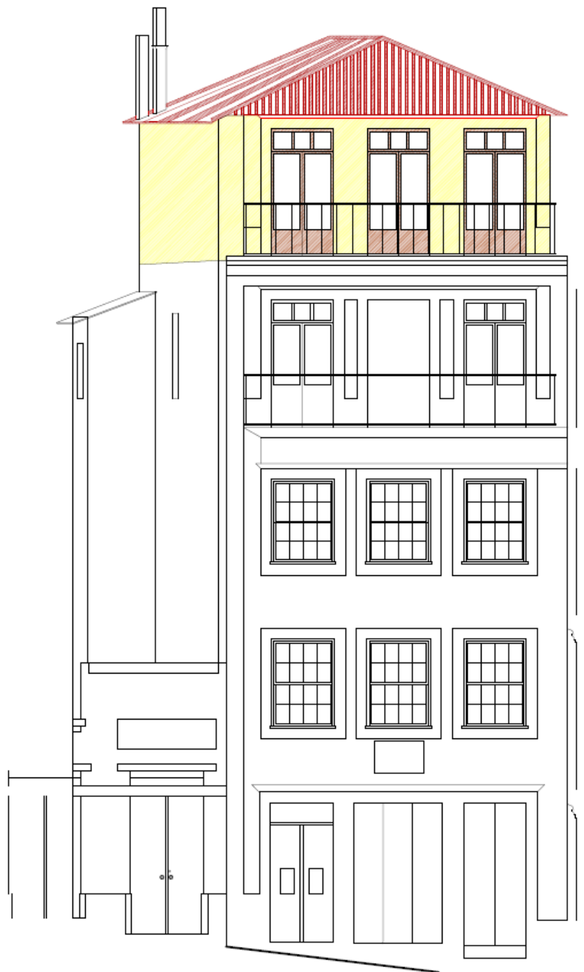
Figura 6.14 - Revestimento exterior da ampliação (Vista Frontal)
