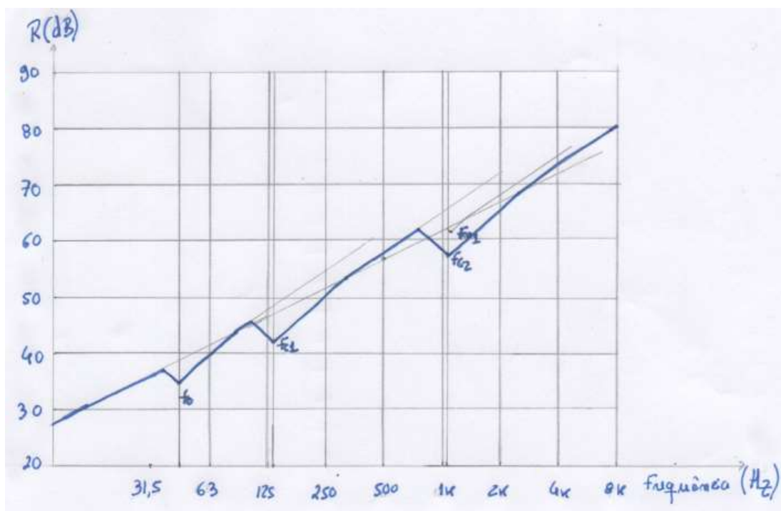
Figura 6.51 - Comportamento teórico do elemento construtivo constituído por uma parede de alvenaria de 30 cm, uma caixa de ar de 15 cm e uma parede de gesso cartonado de 1,5cm, em função das bandas de frequência de oitava.
