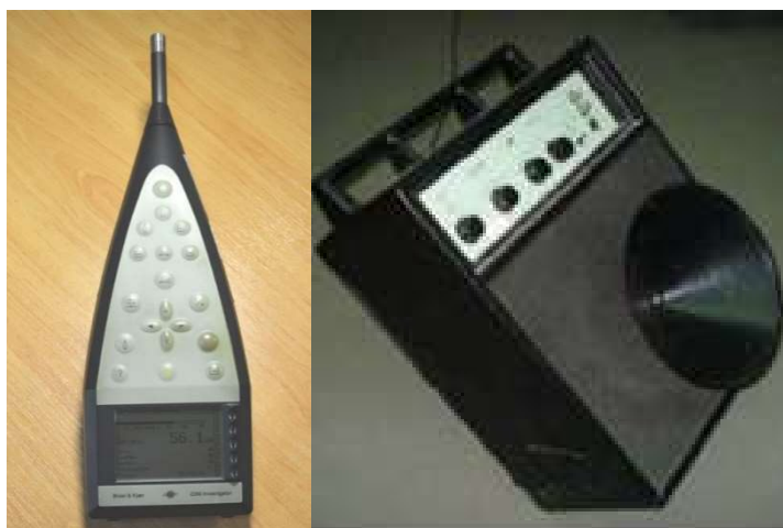
Figura 5.1 - Equipamento utilizado na medição do tempo de reverberação no auditório do cineteatro de Esmoriz (à esquerda, o sonómetro B&K2260 e à direita a fonte sonora B&K4224 ) [Fotos de Autor].
