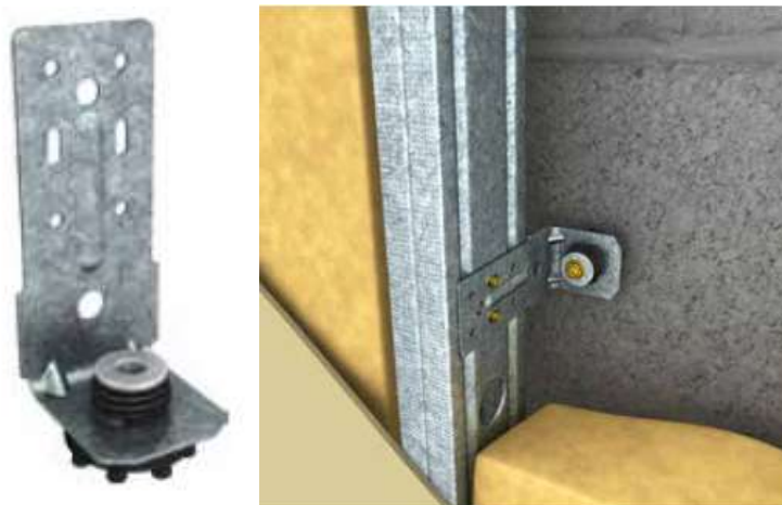
Figura 6.52 - Dispositivo resiliente da marca Rondo usado para unir os dois paramentos do elemento construtivo composto por uma parede de alvenaria e por uma parede de gesso cartonado. [61]
