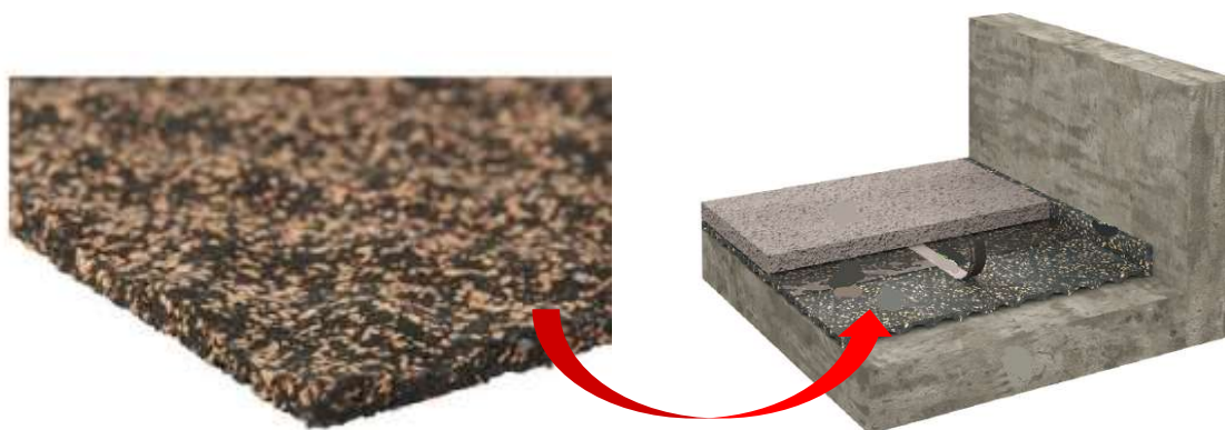
Figura 6.53 - Aglomerado de cortiça a ser utilizado como material resiliente no pavimento da zona envolvente do auditório [62].
