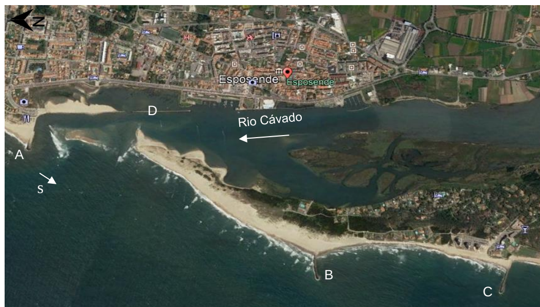
Fig. 29 - Caracterização do estado atual da embocadura do rio Cávado e obras costeiras existentes: A) molhe Norte; B) esporão da restinga; C) esporão da praia de Ofir; D) dique. s) sentido da deriva litoral (Google Earth, 2019).
