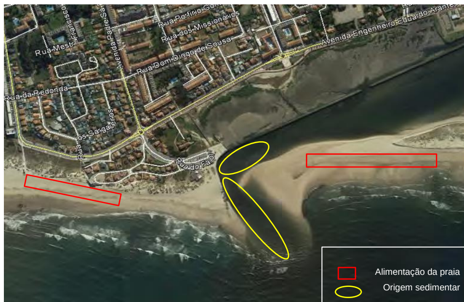
Fig. 54 - Origem dos sedimentos dragados na embocadura do rio Cávado e alimentação artificial da praia de Suave-Mar e da restinga de Ofir adaptado de (Polis, 2016).
