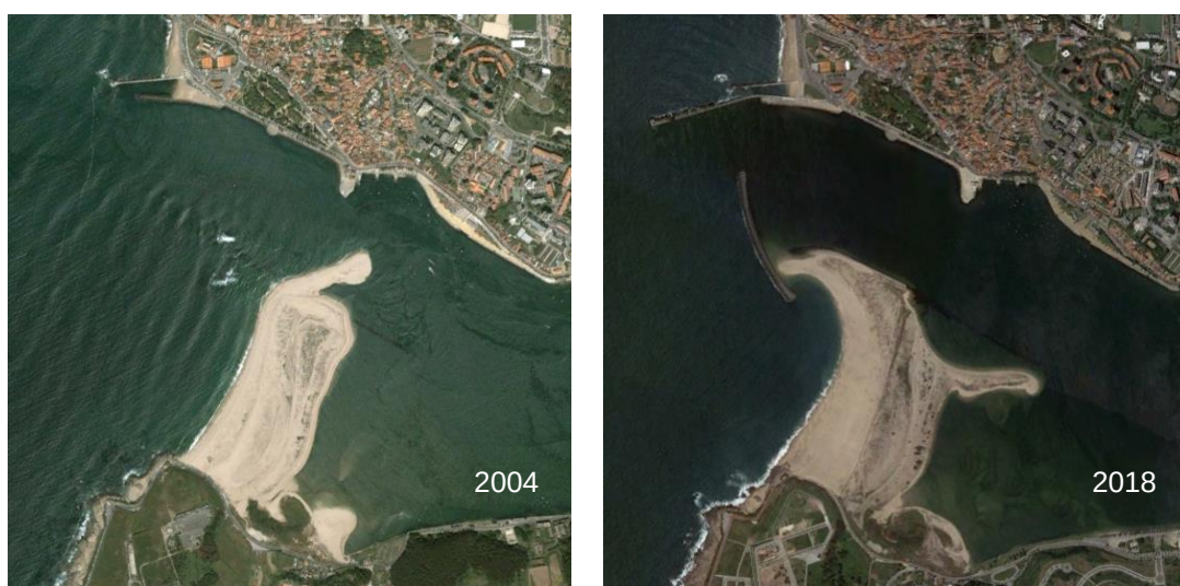
Fig. 12 - Evolução da embocadura do rio Douro antes e após a colocação do molhe Norte e do quebramar destacado. Imagens de satélite (Google Earth).
