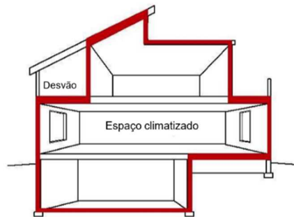
Figura 22 - Delimitação da envolvente do edifício
