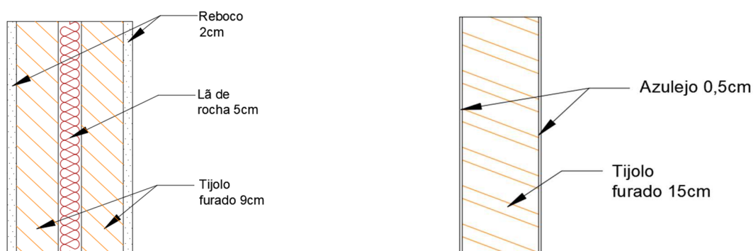
Figura 64 - Desenho de pormenor das paredes interiores que contactam com espaços não úteis
