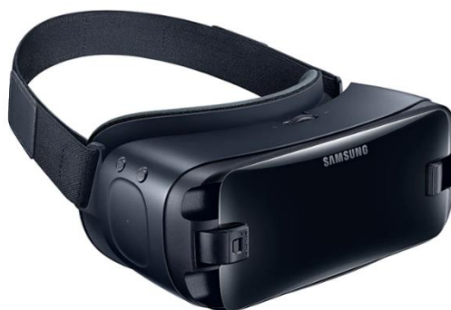
Figura 45 - Head Mounted Display que permite o uso de telemóvel para visualizar realidade virtual [103].
