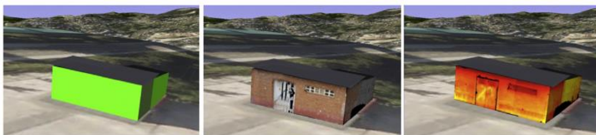
Figura 42 – a) Metodologia utilizada para fusão de imagem; b) Modelo BIM final com texturas [96].
