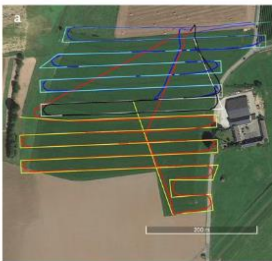
Figura 37 – Comparação entre o percurso planeado a ser realizado (Linhas retilíneas) e o percurso realizado (Linhas onduladas) [86].
