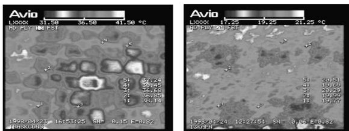
Figura 32 – Distribuição irregular da temperatura provocado por uso de argamassa incompatível [68].
