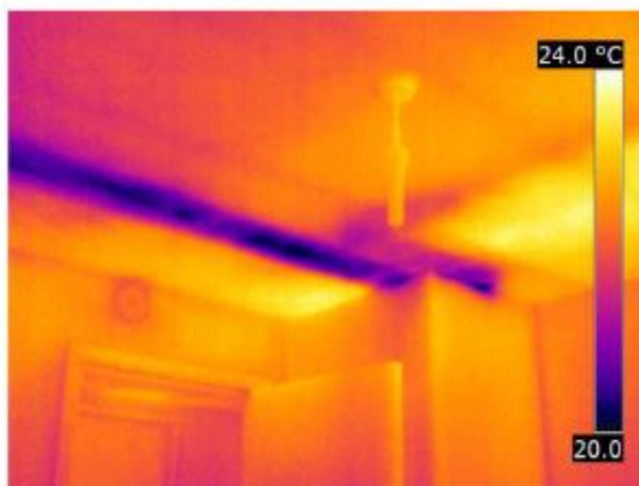
Figura 26 - Diminuição de temperatura superficial provocado por sistema AVAC [35].
