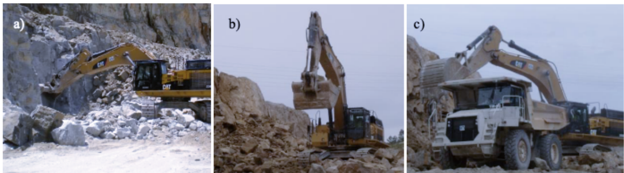
Figura 3 - Pá Carregadora Giratória em operação no seu ciclo de trabalho de carga. a) Operação de arrumo do material desmontado; b) Com o balde carregado em espera; c) Carga do Dumper . Fonte (Bernardo, 2013)
