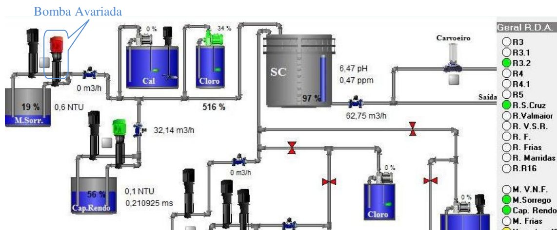
Figura 7.13 – Visualização de um dos alarmes visuais na detecção de avaria de uma bomba
