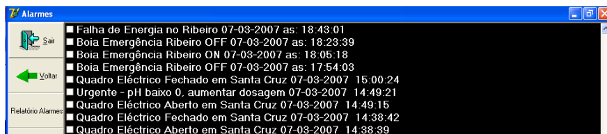
Figura 7.17 - Detecção de falha de energia
