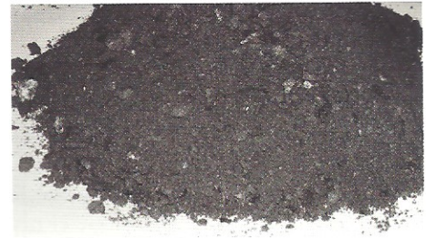
Figura 2 – Aspecto geral da escória após a primeira moagem
