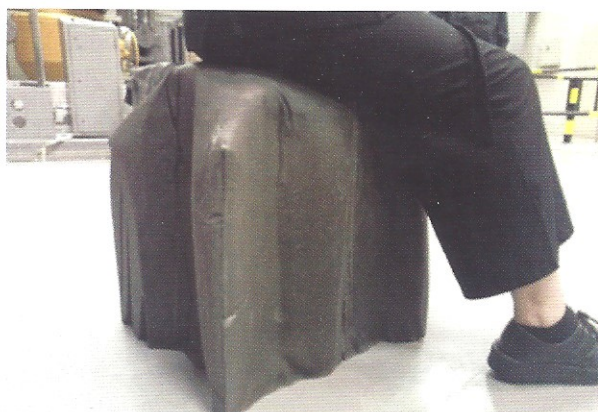
Figura 4 – Ensaio de usabilidade no banco fissurado, onde se destaca a textura da lona
