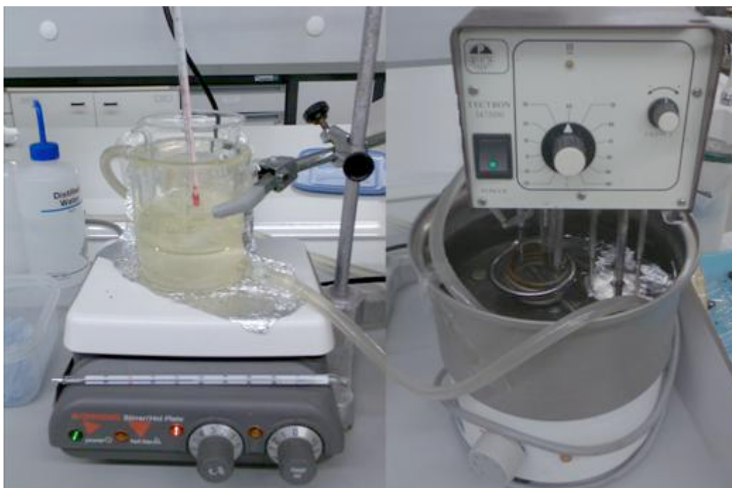
Figura 20 - Instalação usada para a oxidação do BaP pelo reagente de Fenton em matrizes aquosas.
