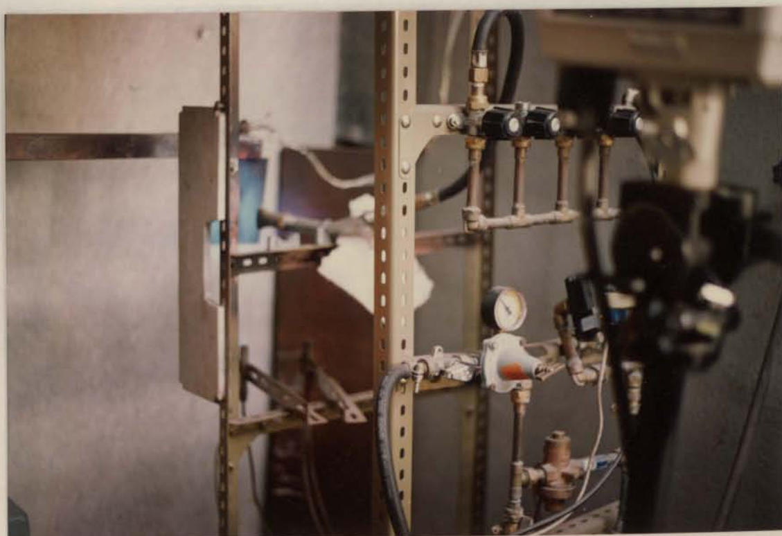
Fig.6.7 - Pormenor do queimador com a chama a incidir directamente sobre a amostra.
