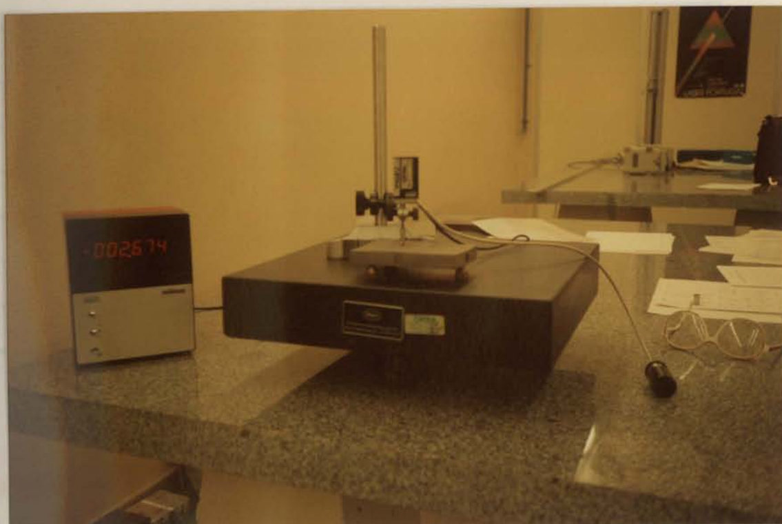
Fig.6.5 - Amostra a ensaiar colocada sobre os três suportes existentes no plano.
