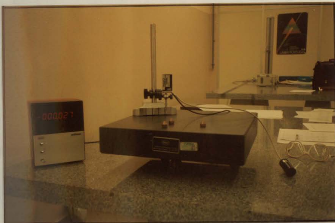
Fig.6.4 - Plano de granito "00", suportes da amostra e comparador electrónico (à esquerda).
