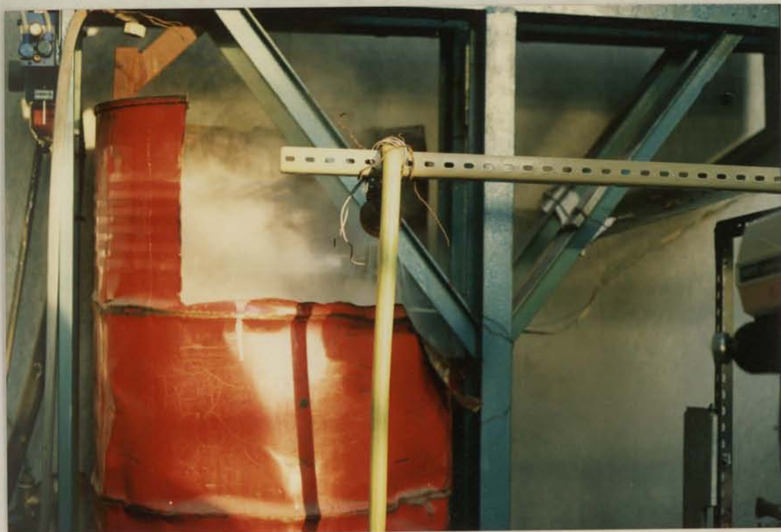
Fig.6.8 - Pormenor do sistema de arrefecimento, com o respectivo chuveiro.
