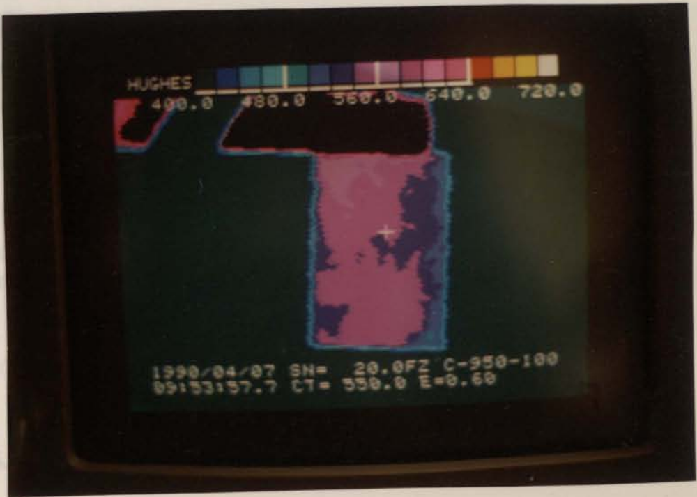
Fig. 6.26 - Cobre-Crómio - Fim do aquecimento - Temperatura máxima lida no termopar 565°C.
