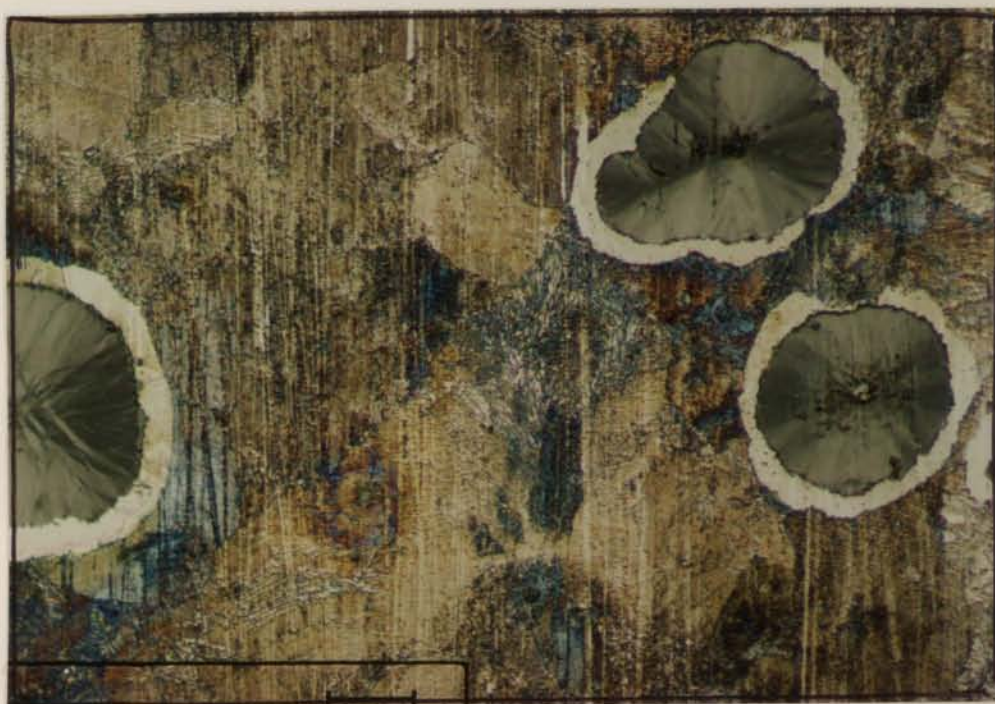
Fig.6.35-- A mesma amostra que 6.33, mas com maior ampliação. Ausência de fissuras.
