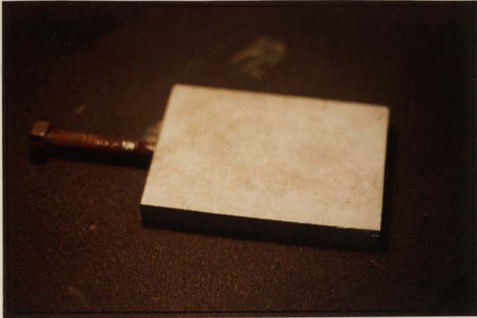
Fotog.2.1 - Peça fresada e roscada na extremidade superior
