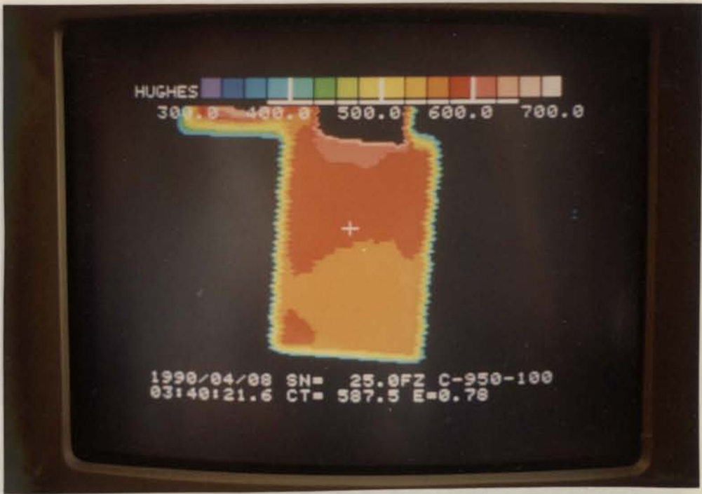
Fig.6.15 - Ferro Nodular Ferrítico - Fim do arrefecimento. Temperatura mínima lida no termopar 340°C
