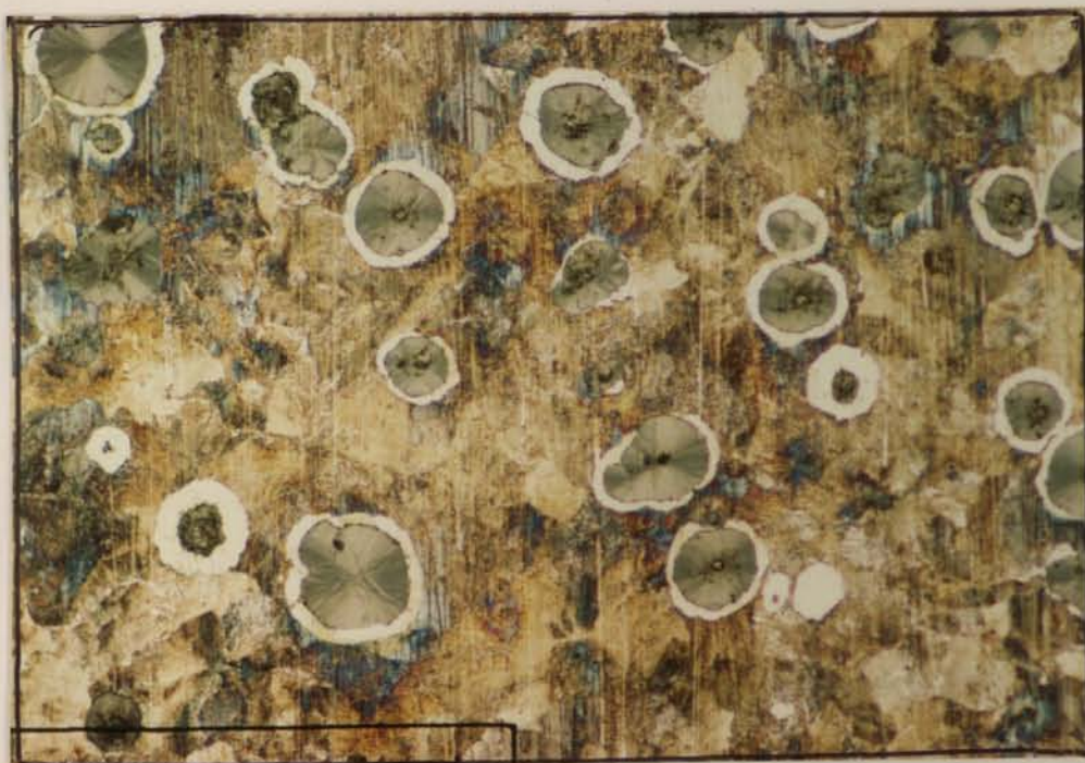
Fig.6.33 - Ferro nodular perlítico, após 100 ciclos térmicos. Matriz perlítica com alguma ferrite em volta dos nódulos de grafite ("olho de boi"). Ausência de fissuras.
