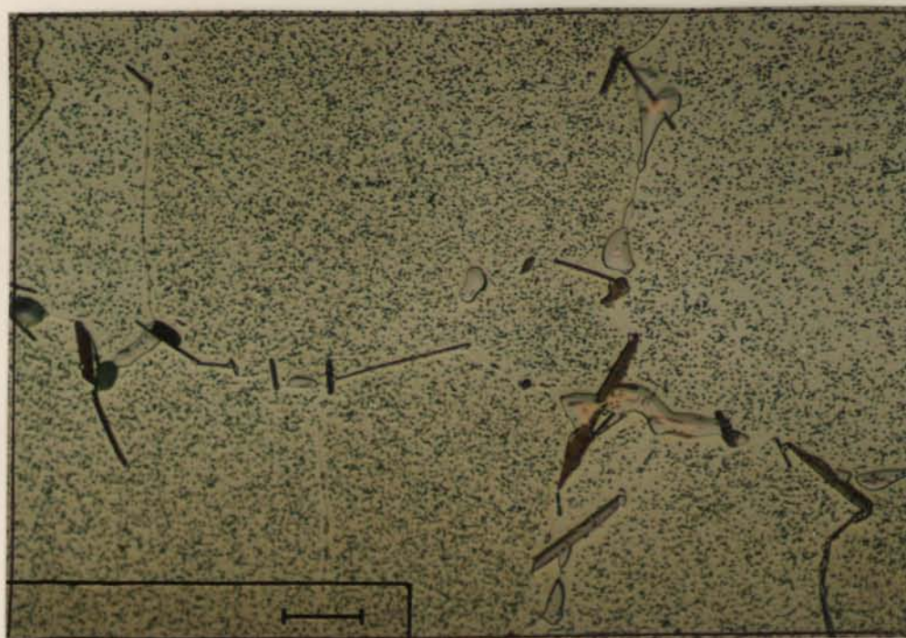
Fig.6.45 - A mesma amostra que 6.43, mas com maior ampliação. Precipitação microscópica do \text{Al}_2\text{Cu} . É nítida a fase \text{Al}_2\text{CuMg} , assim como as agulhas de \text{Cu}_2\text{FeAl}_7 . Liga tratada termicamente. Ausência de fissuras.
