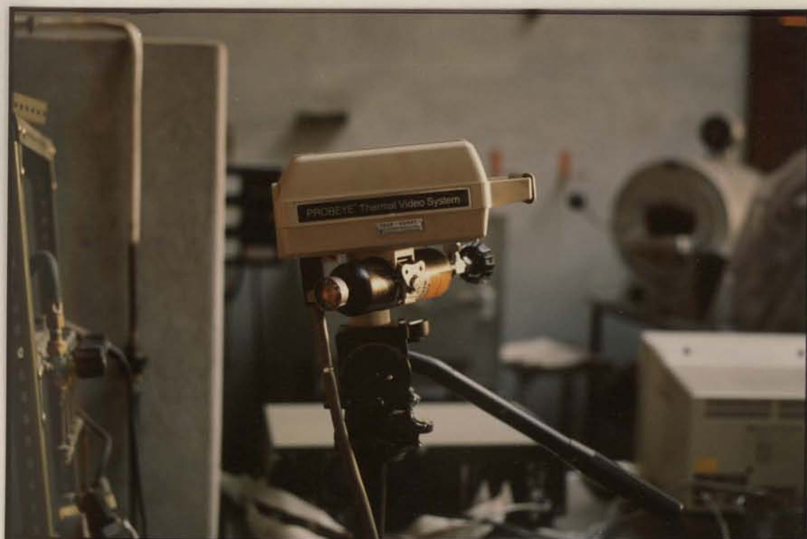
Fig.6.11 - Registrador de imagem de infra-vermelhos a incidir sobre a placa.
