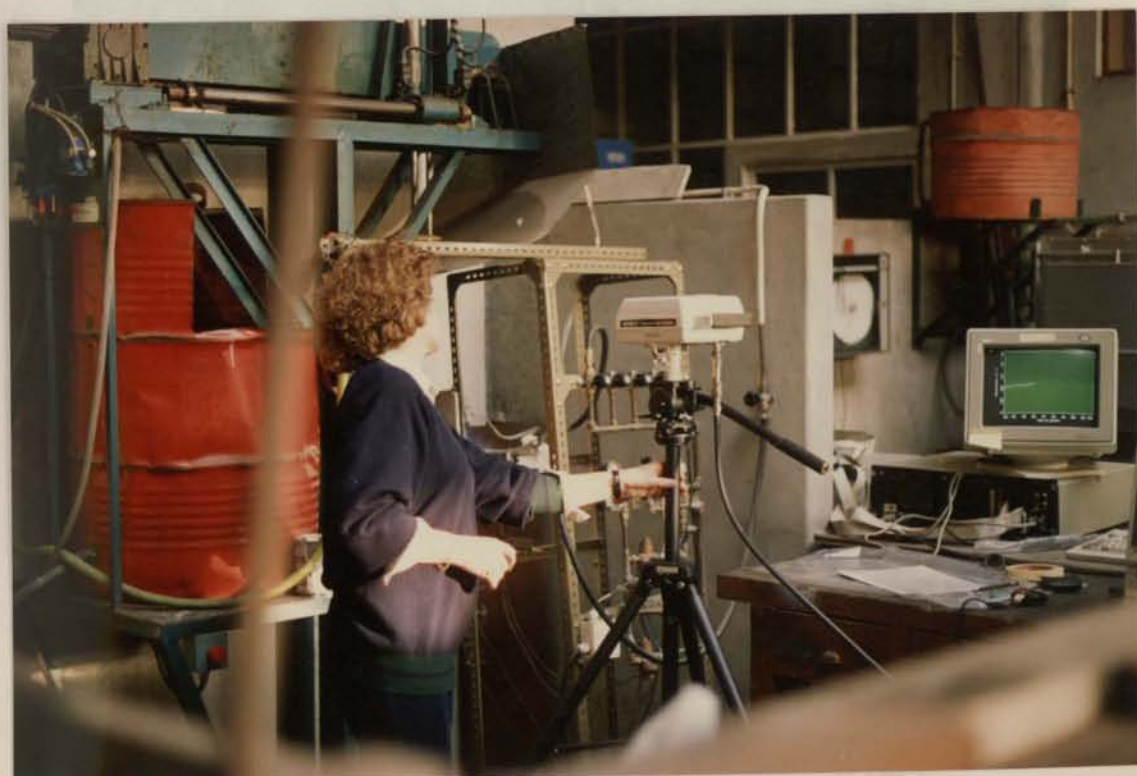
Fig.6.13 - Representação de um ensaio. No ecrã do monitor do computador poderá ver-se a evolução de uma curva na fase de aquecimento.
