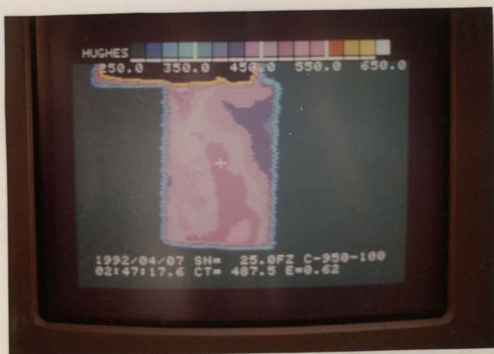
Fig.6.24 - Alumínio-Cobre - Fim do aquecimento - Temperatura máxima lida no termopar 500°C.
