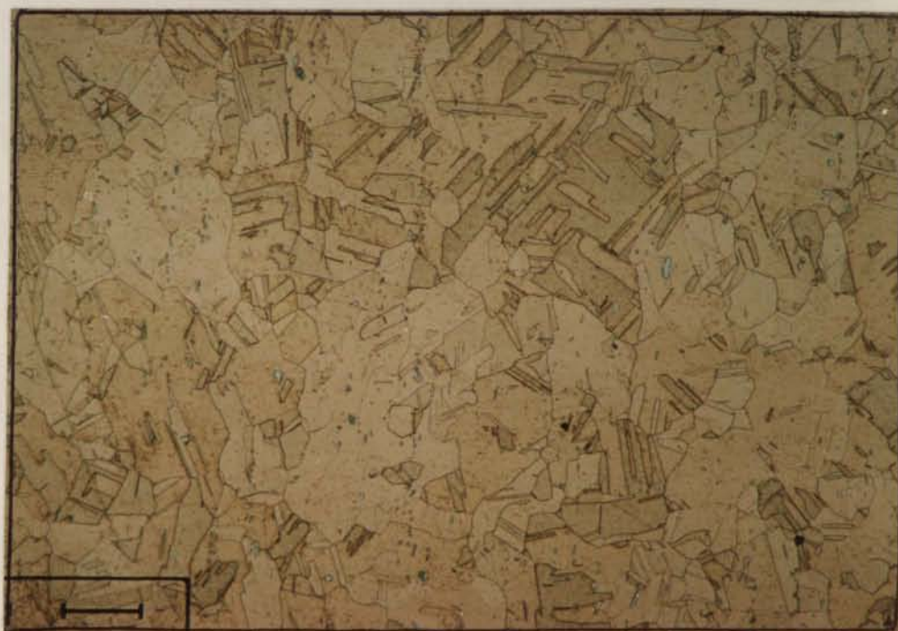
Fig.6.47 - Liga de cobre-níquel após 100 ciclos, fase \alpha bem delineada, fase rica em Cr (Verde). Ausência de Fissuras.
