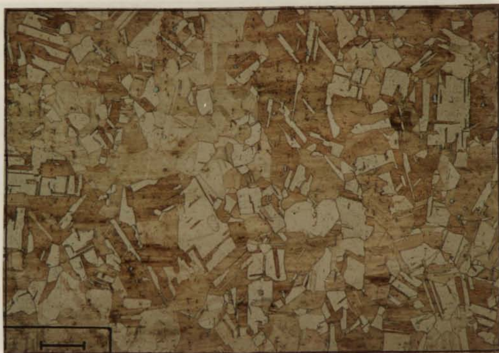
Fig.6.46 - Liga de cobre-níquel, forjada e tratada térmicamente pelo fornecedor, fase \alpha bem delineada, fase rica em Cr (Verde)-
