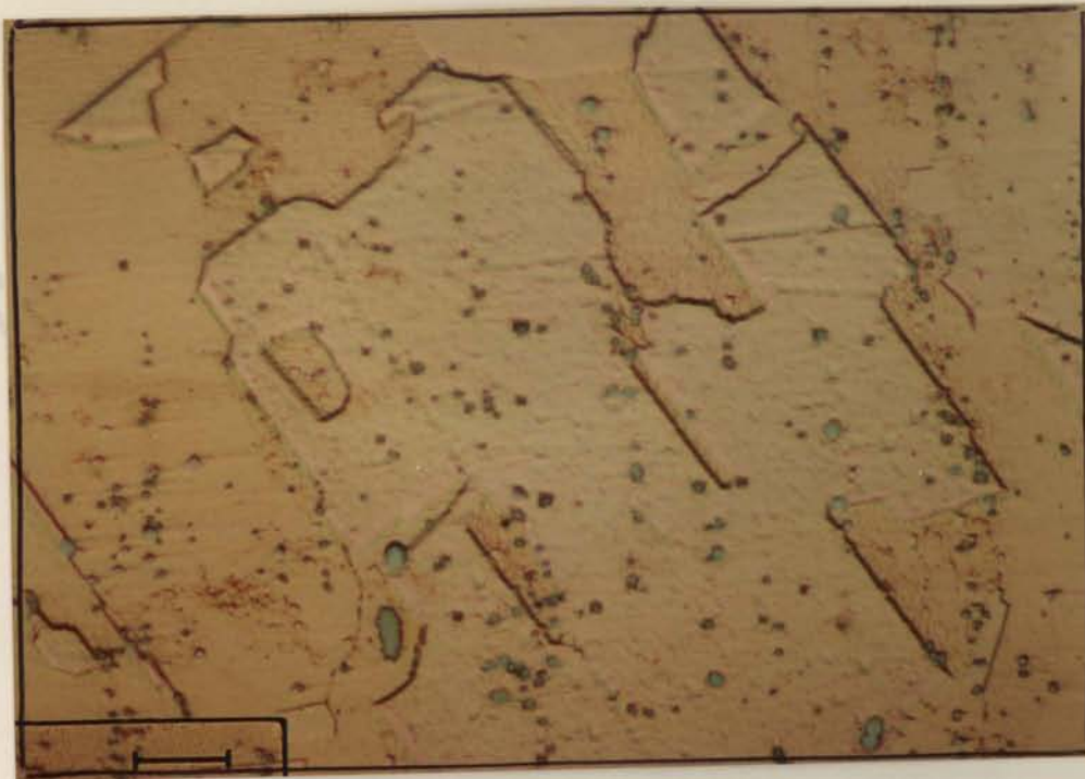
Fig.6.52 - A mesma amostra que 6.50 mas com maior ampliação. Fase \alpha e fase rica em Cr e ZrCu_3 bem evidenciada.
