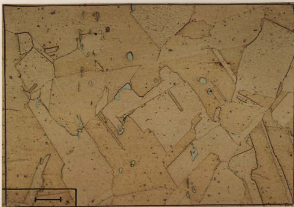
Fig.6.49 - A mesma amostra que 6.47, mas com maior ampliação. Matriz \alpha e fase rica em Cr (a verde). Precipitados de níquel-silício no interior dos grãos e nas juntas de grão. Ausência de fissuras.
