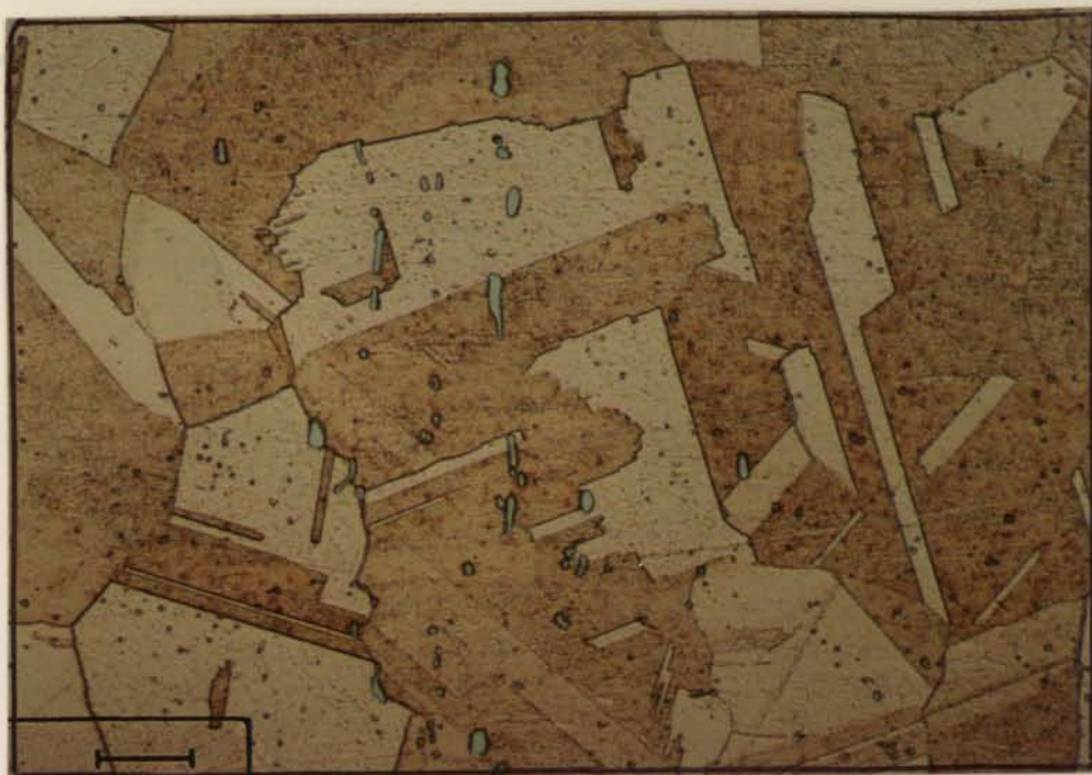
Fig.6.48 - A mesma amostra que 6.46, mas com a maior ampliação. Matriz de solução sólida \alpha . Precipitados de níquel-silício, no interior dos grãos e nas juntas de grão, fase rica em Cr. (a verde).
