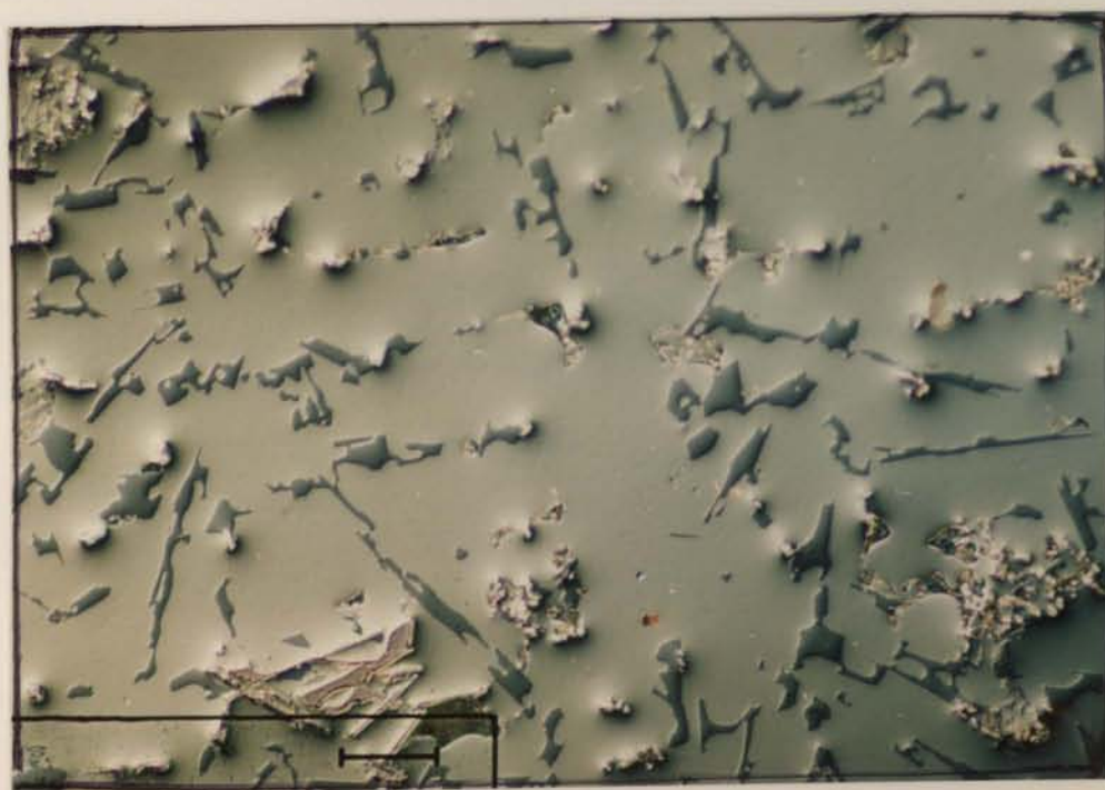
Fig.6.39 - A mesma amostra que a anterior, mas fotografada com contraste interferencial diferencial (DIC).
