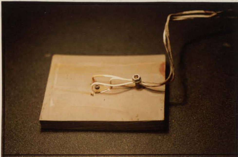
Fotog.2.2 - Placa instrumentada (já ensaiada) com termopares "CHROMEL-ALUMEL"
