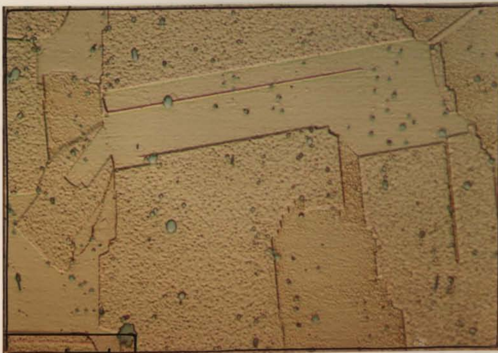
Fig.6.53 - A mesma amostra que 6.51, mas com maior ampliação. Fases bem diferenciadas e ausência de fissuras.
