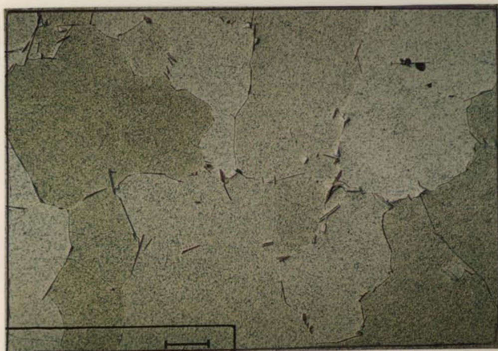
Fig.6.42 - A mesma amostra que 6.40, a maior ampliação e fotografada com contraste interferencial diferencial. Aqui está mais evidenciada a fase \text{Al}_2\text{CuMg} (amarelada) assim como as agulhas de \text{Cu}_2\text{FeAl}_7 .
