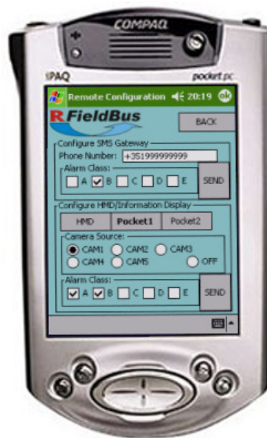
Figura 5.3: Imagem do Compaq iPAQ 3870 executando uma versão Cliente Intranet em eMVB3.0 (visualização da janela equivalente à Config_Devices_Form da versão para plataforma PC – Figura 5.8c deste capítulo)
