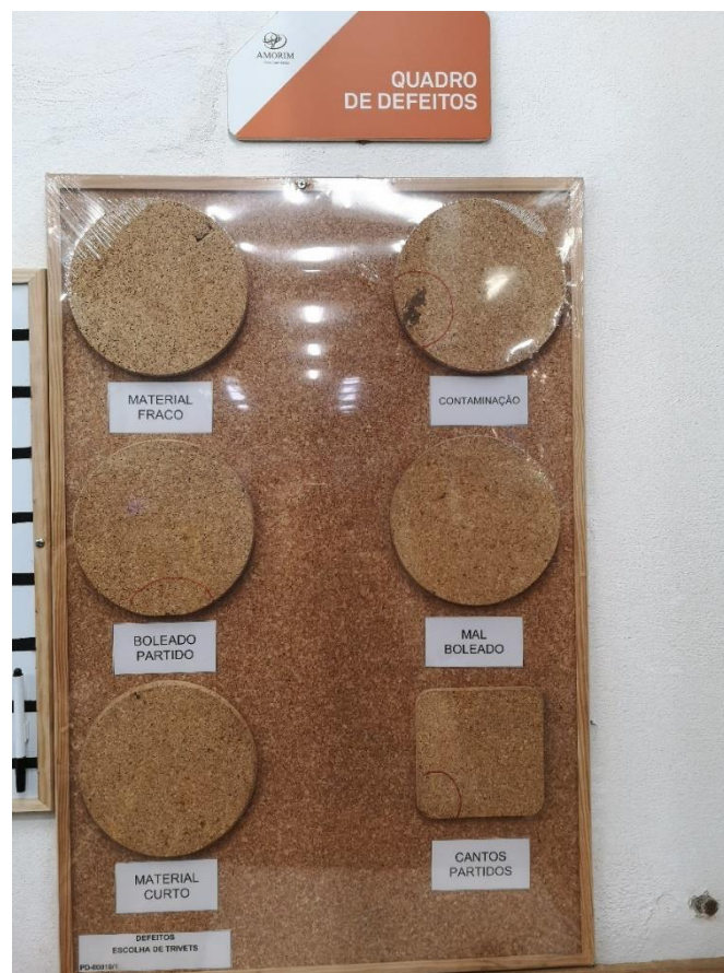
Figura 21 - Quadro de defeitos
