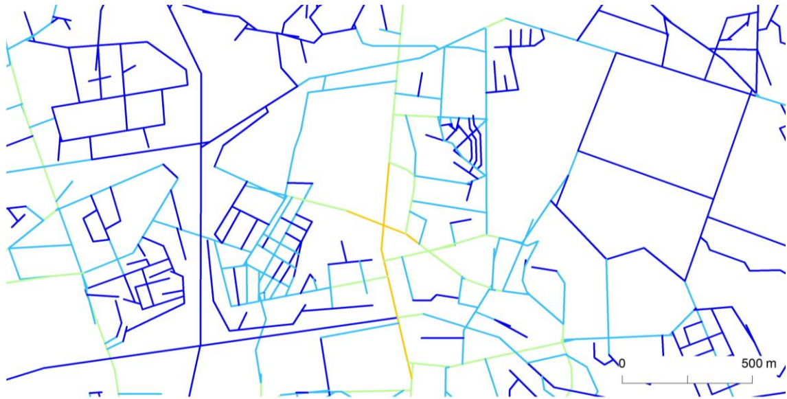
Análise angular de segmentos: integração local raio 1.000
