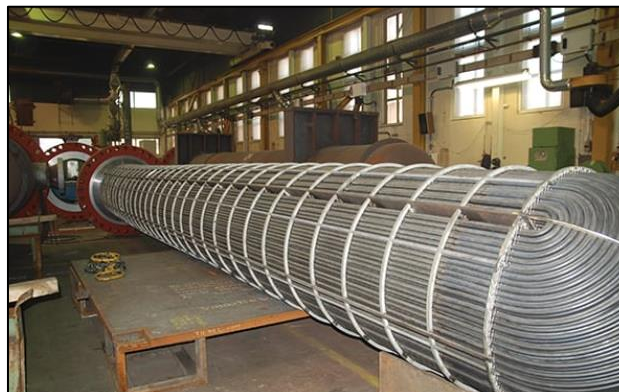
Figura 15 - Fotografia de um permutador de carcaça e tubo, sem carcaça [35]
