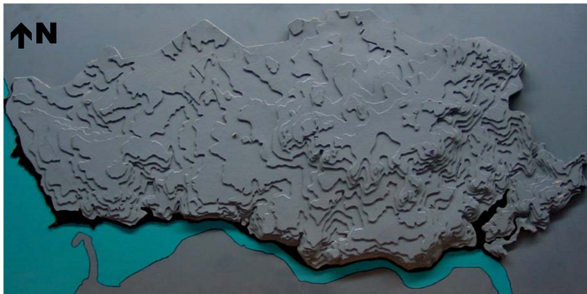
Fig. 3.5 – Maqueta da cidade do Porto construída com base na carta hipsométrica à escala 1: 10.000 da Câmara do Porto (Trabalho realizado pelo Eng.º Mário Escudeiro no âmbito de um estágio PRODEP em climatologia).
