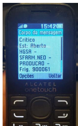
Anexo 26 - Dispositivo telefónico de emissão de alertas de temperatura e humidade de setores dos SF.
