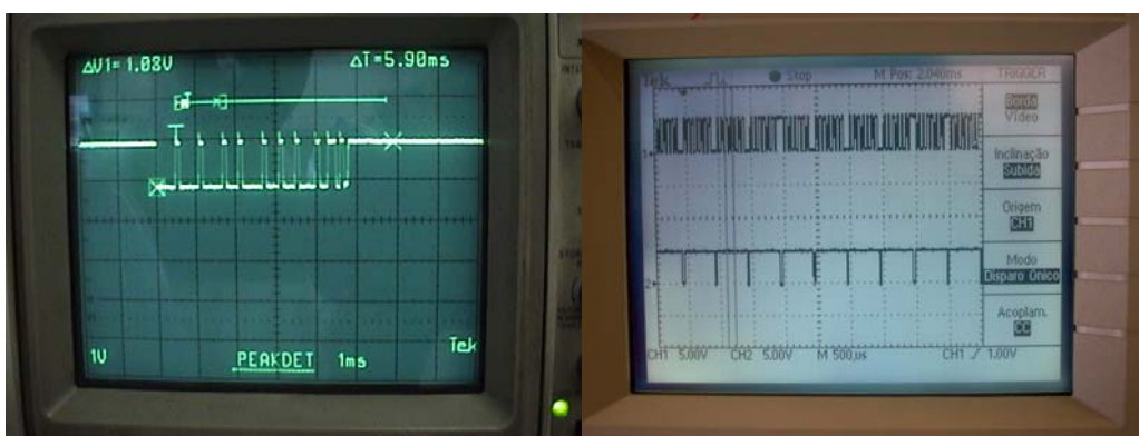
Figura 51 – Trama de mensagem CAN observada num: osciloscópio semi-digital (à esquerda); osciloscópio digital (à direita).
