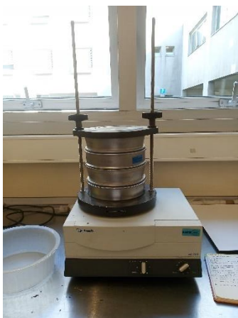
Figura 2. 3. Processo de crivagem num agitador de peneiros para separação das sementes da biomassa dos capítulos.
