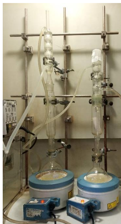
Figura 2. 7. Extração sólido-líquido do óleo das sementes de cardo utilizando o método de Soxhlet.
