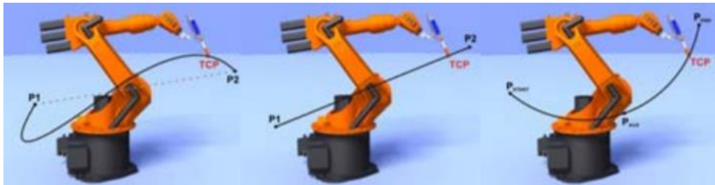
Figura 2.6 - Exemplo dos movimentos básicos em robótica industrial, da esquerda para a direita: movimento de juntas, movimento linear e movimento circular(Abreu 2018)
