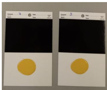
Figura 30- Exemplo de aplicação do produto a analisar utilizando a técnica da gota sobre carta de contraste (amostra para teste- pasta corante PY 42).
