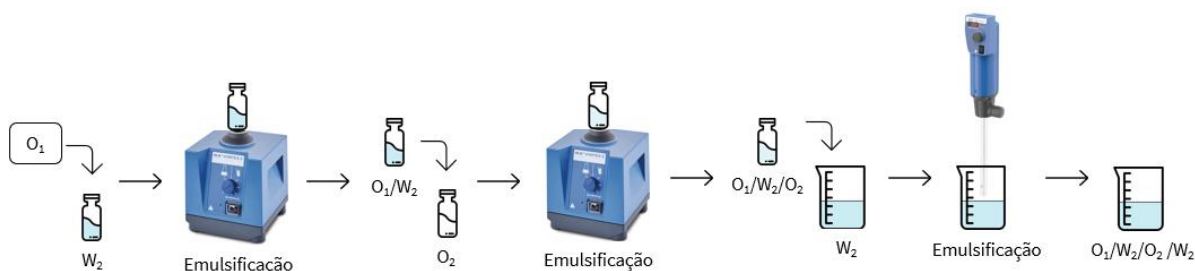
Figura 6. Esquema representativo do procedimento de múltipla emulsão
