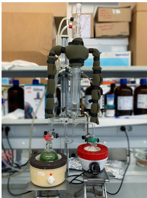
Figura 4. Extração do óleo essencial pela técnica DES
