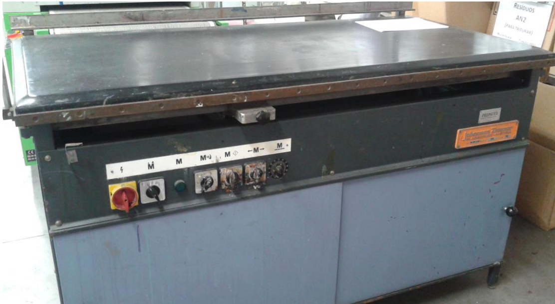
Figura 27 - Mesa de estampar utilizada na estampagem de retângulos 5 \times 1 \text{ cm}^2 nos materiais candidatos a substrato do sensor.
