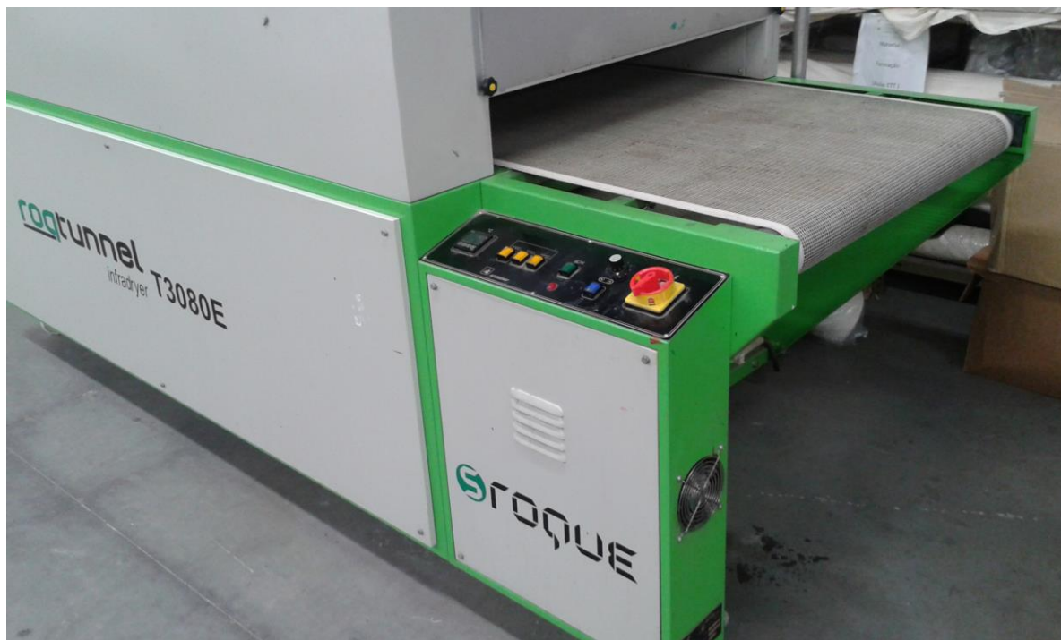
Figura 29 - Secadeira S.roque com tapete rolante utilizada na secagem após estampagem dos possíveis substratos do sensor.
