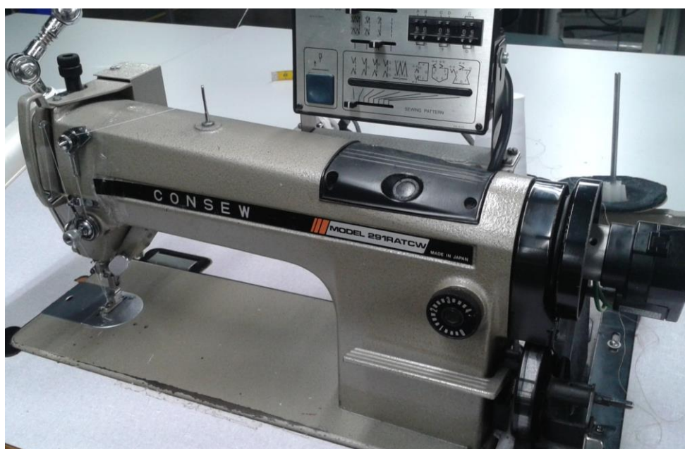
Figura 33 - Máquina de costura Consew utilizada para a costura em ponto preso.
