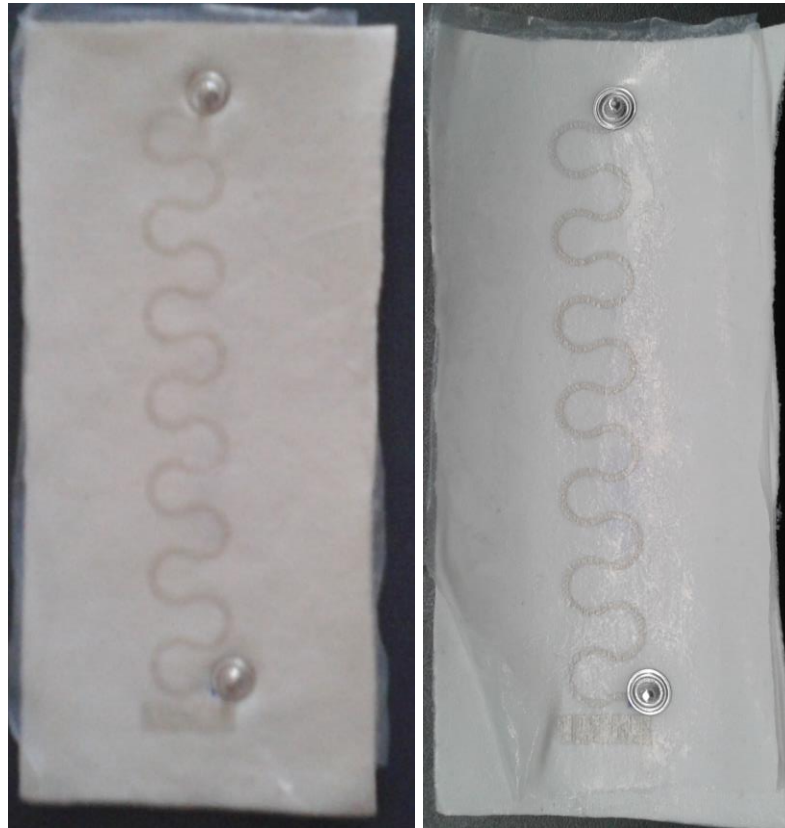
Figura 42 - Imagens do substrato composto pela membrana 2 e a cola web . À esquerda antes das lavagens e à direita após 40 lavagens.
