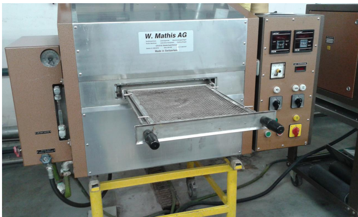
Figura 30 - Secadeira Mathis utilizada no processo de cura após o processo de secagem dos materiais candidatos a substrato do sensor.
