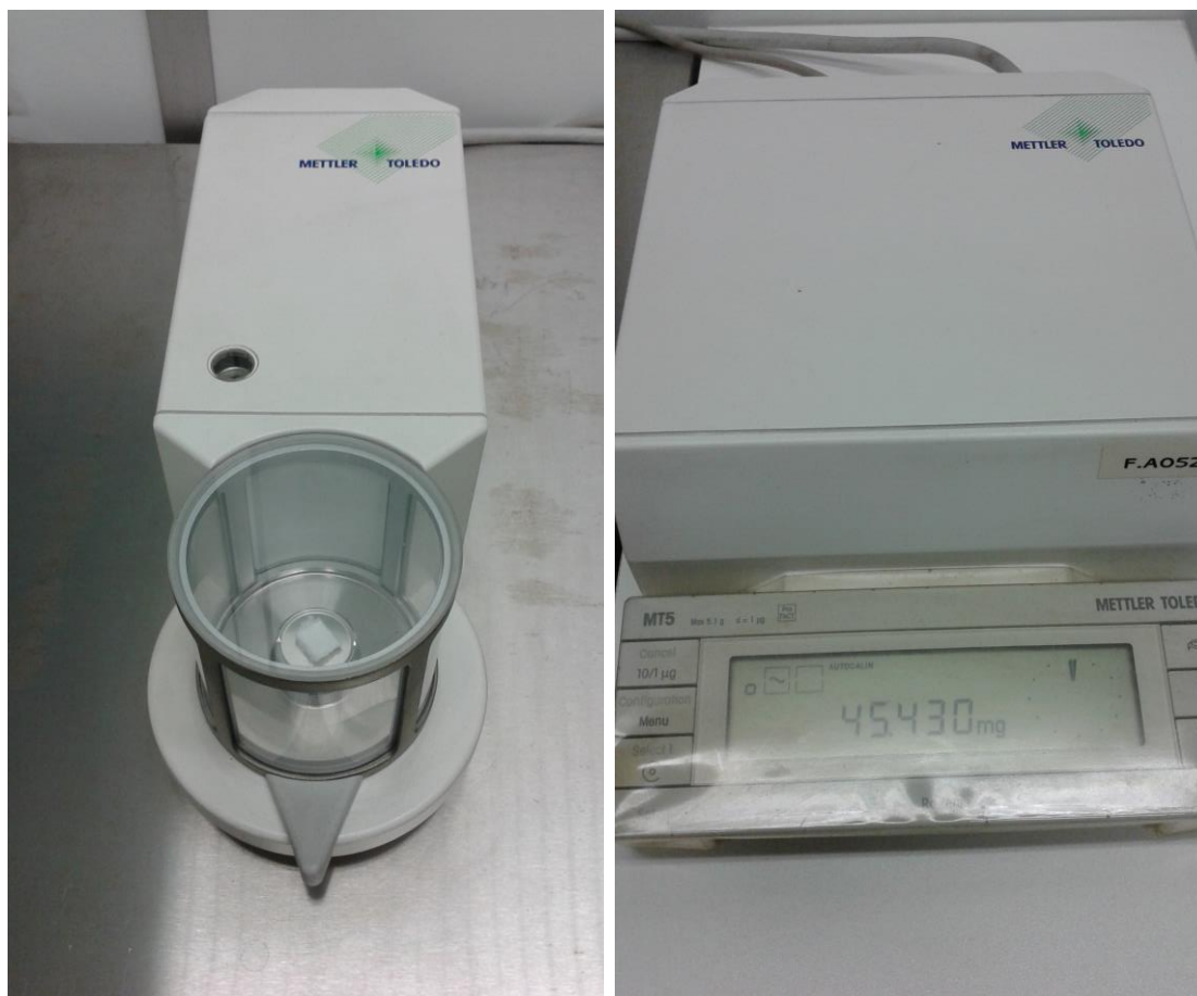
Figura 40 - Balança de precisão utilizada nas pesagens dos candidatos a substrato do sensor.
