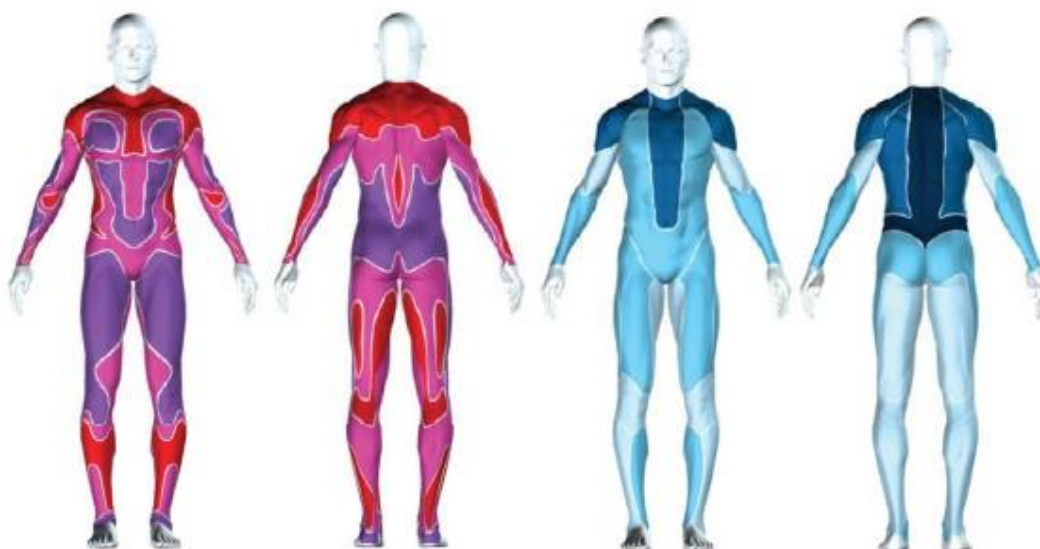
Figura 9 - Mapas de distribuição de temperatura corporal (os dois manequins à esquerda) e regiões de transpiração (os dois manequins à direita) usados para elaboração de roupas respiráveis, onde as cores mais escuras representam zonas de maior temperatura e transpiração, respetivamente [48].
