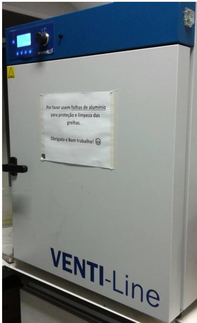
Figura 38 - Estufa utilizada na secagem das amostras estampadas no CENTI.
