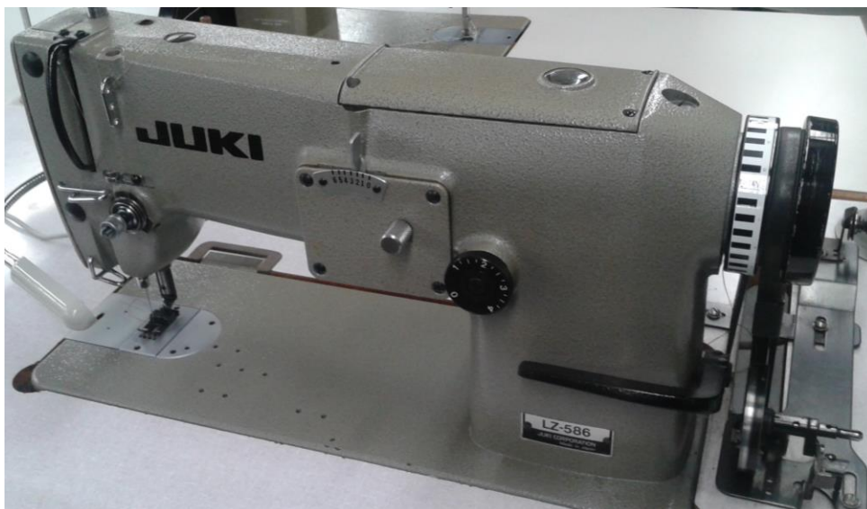
Figura 34 - Máquina de costura Juki utilizada para a costura em zig-zag.
