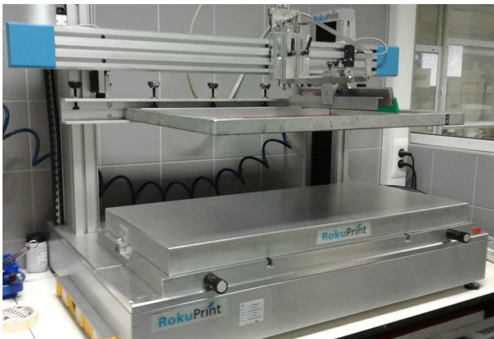
Figura 36 - Máquina de estampar automática utilizada na estampagem dos circuitos em filmes/membranas de encapsulamento no CENTI.
