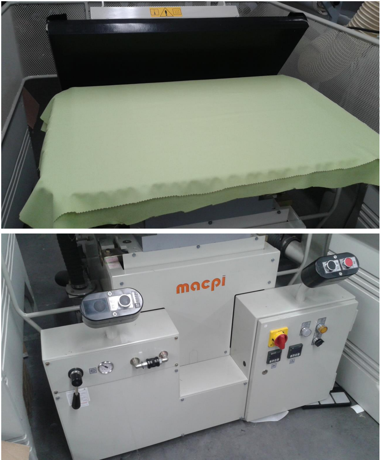
Figura 31 - Prensa macpi utilizada no processo de laminação para a criação dos candidatos a substrato do sensor, para a adesão dos filmes/membranas e dos transferes.
