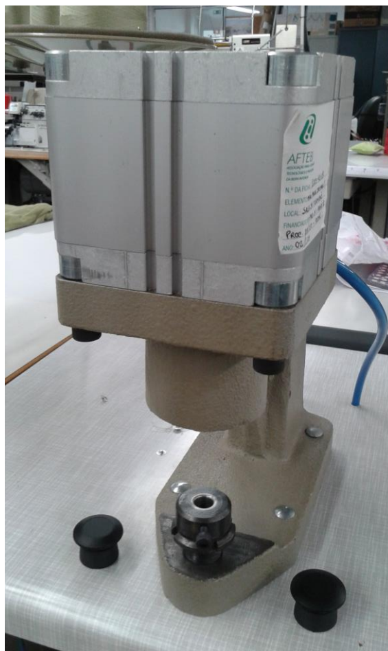
Figura 39 - Máquina utilizada para aplicação dos botões snap nos circuitos impressos nos filmes/membranas e nos transferes condutores.
