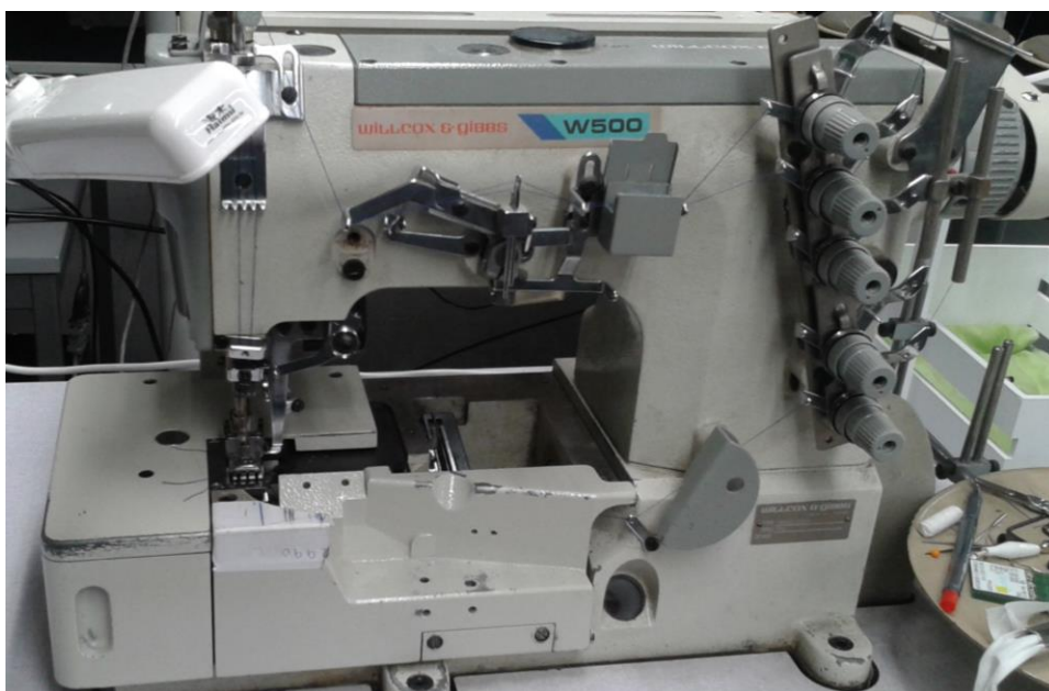
Figura 35 - Máquina de costura Willcox and Gibbs utilizada para a costura por ponto cadeia.
