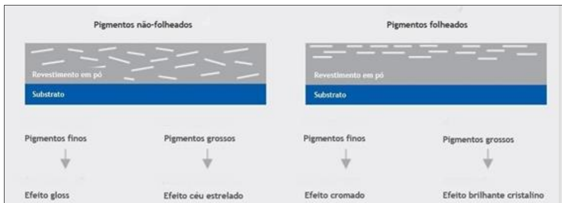
Fig 1. Ilustração dos efeitos metalizados produzidos pelas diferentes orientações dos pigmentos de alumínio (adaptado de [23]).
