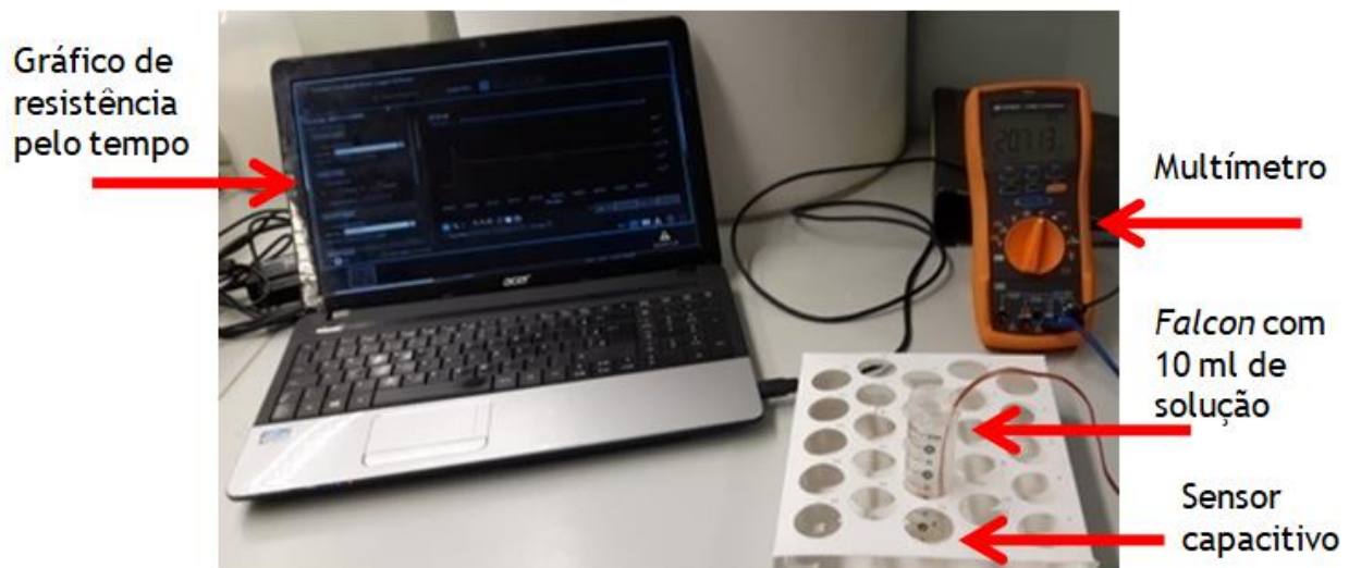
Figura A.4.2 - Setup de medição para os sensores interdigitados resistivos.
