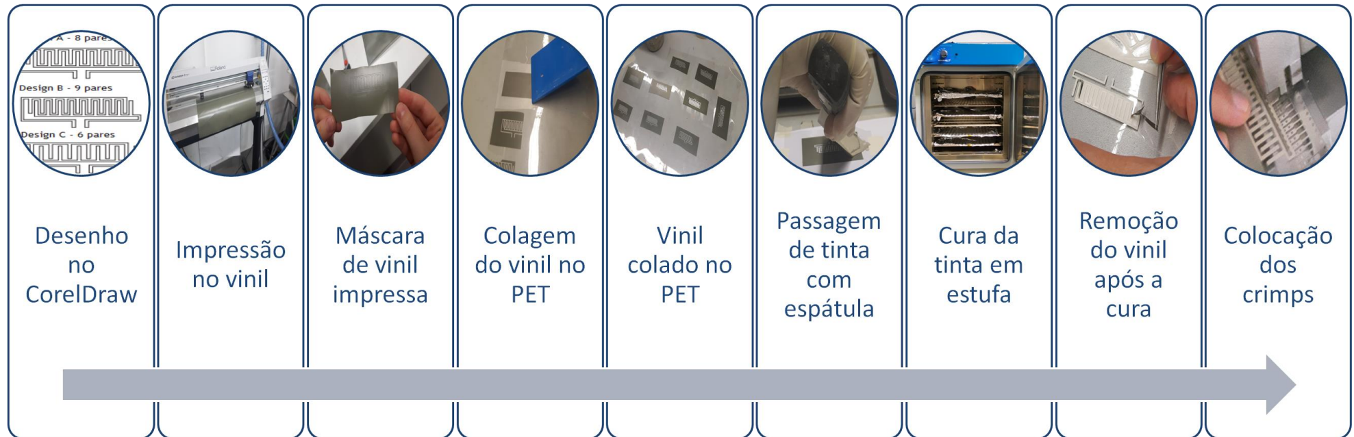
Figura A.2.1 - Esquema do processo de impressão manual.
