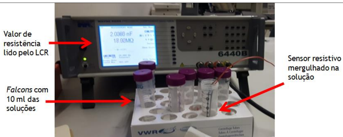
Figura A.4.3 - Setup de medição para os sensores resistivos utilizando o LCR.
