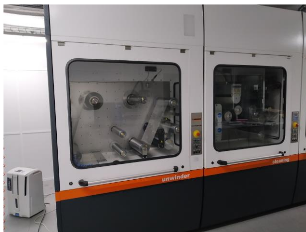
Figura 2.3.1 - Impressão Roll-to-roll na máquina microFLEX™, instalada no CeNTI.
