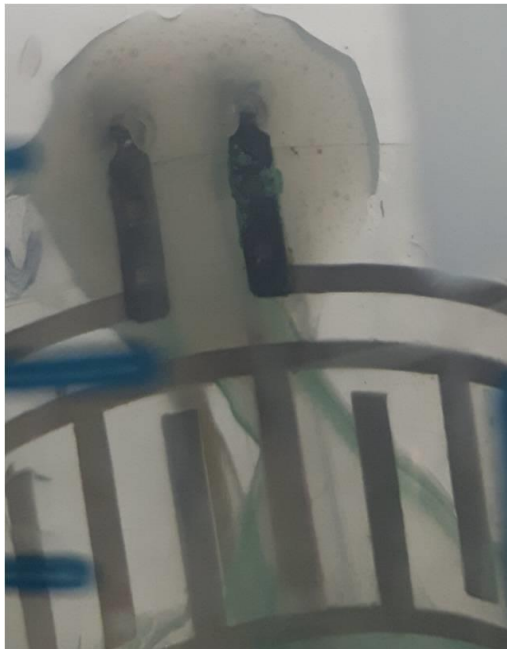
Figura 4.2.1 - Degradação do crimp metálico.
