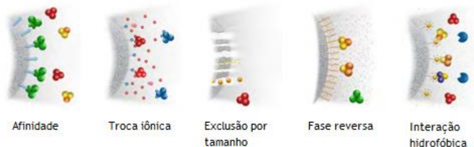
Figura 2.1.1 - Princípio de atuação de diferentes tipos de cromatografia[adaptada de 11].
