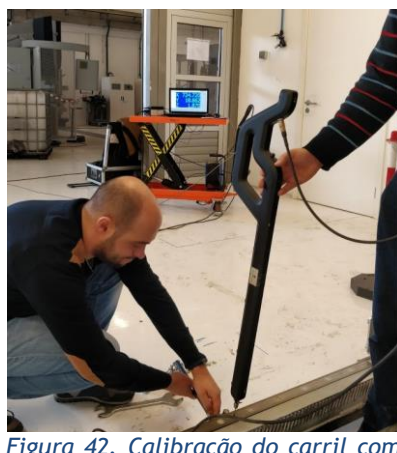
Figura 42. Calibração do carril com recurso ao Metronor Solo.
