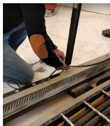
Figura 43. Pormenor da calibração do carril com recurso ao Metronor
