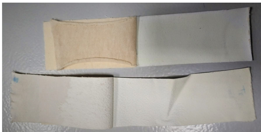
Figura D.4: No topo: exemplo de amostra utilizada no ensaio de adesão ao revestimento de um dos restantes protótipos. Em baixo: amostra utilizada no ensaio de adesão ao revestimento do protótipo 3.
