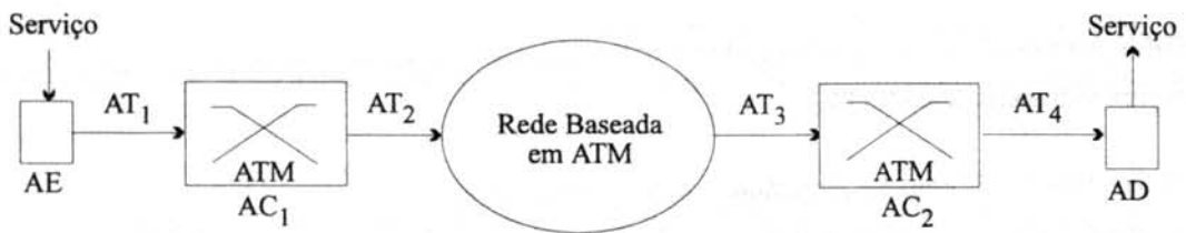
Figura 5.1a Atrasos numa rede ATM (AE- Atraso de Empacotamento; AT- Atraso de Transmissão; AC- Atraso na Comutação; AD- Atraso de Desempacotamento).
