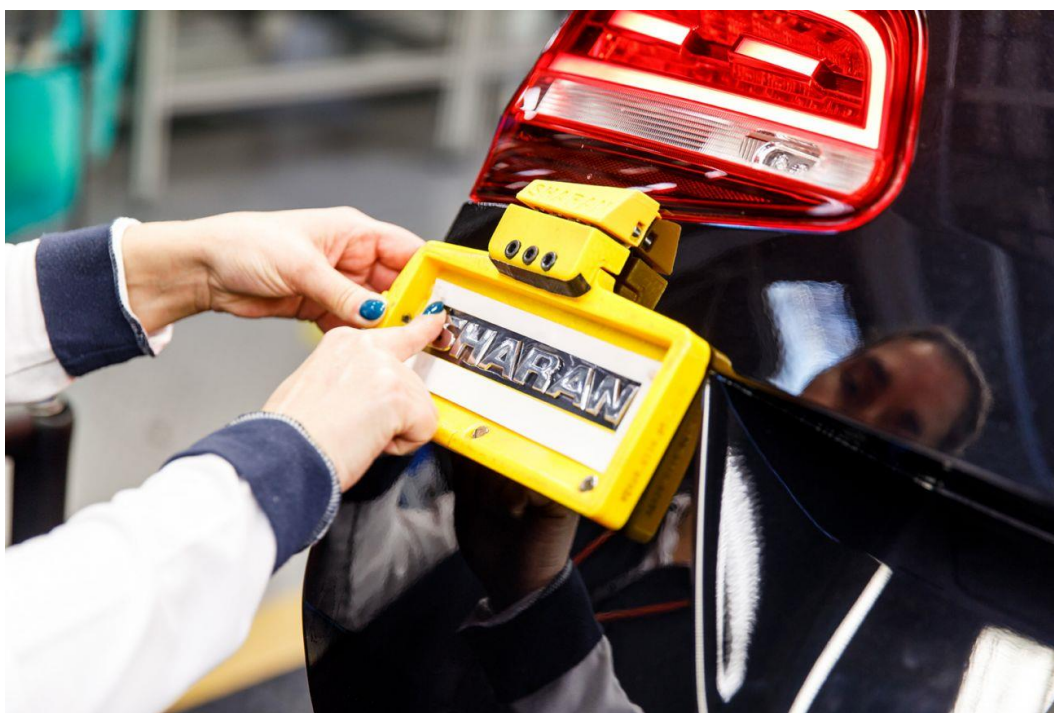
Figura 2.27 – Ferramentas produzidas com recurso à FA na fábrica da Volkswagen Autoeuropa em Portugal
