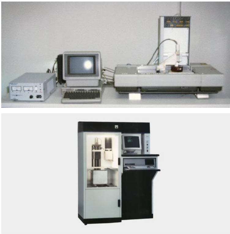
Figura 2.11 – Primeiro sistema de FA, desenvolvido por Charles Hull (em cima). Primeira máquina de FA da 3D Systems, SLA-1, 1992 (em baixo).
