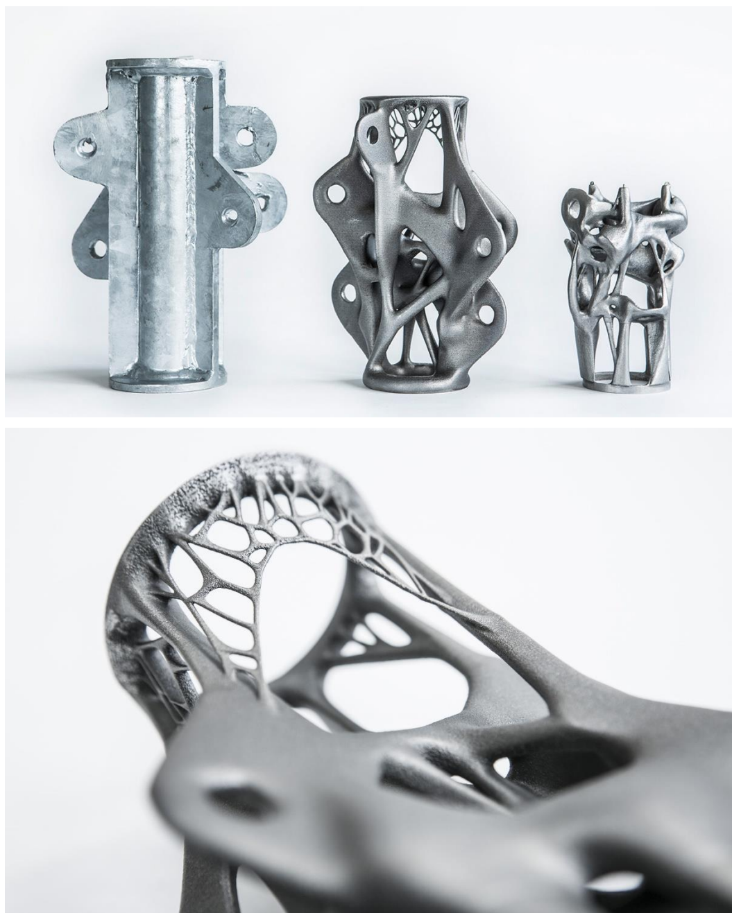
Figura 4.17 – Juntas desenvolvidas pela Arup. Comparação entre o as três juntas: tradicional, “Node 1.0” e “Node 2.0” (em cima); Pormenor da distribuição material no “Node 1.0”.
