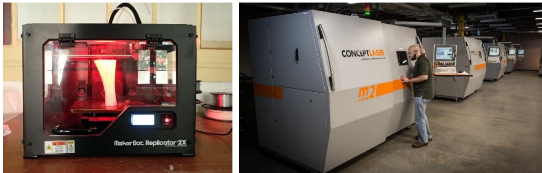
Figura 2.4 – Máquinas de FA. Máquina de secretária, acessível ao consumidor, instalada no DFL/FAUP (esquerda); Máquinas de utilização industrial, para fabricação em metal (direita).
