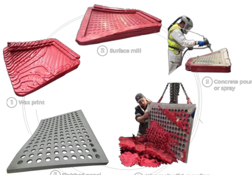
Figura 4.11 – Esquema ilustrativo do processo de produção e reciclagem dos moldes. (da esquerda para direita) deposição seletiva do material, fresagem do acabamento, projeção do GRC, remoção do molde para reciclagem da cera, peça final.
