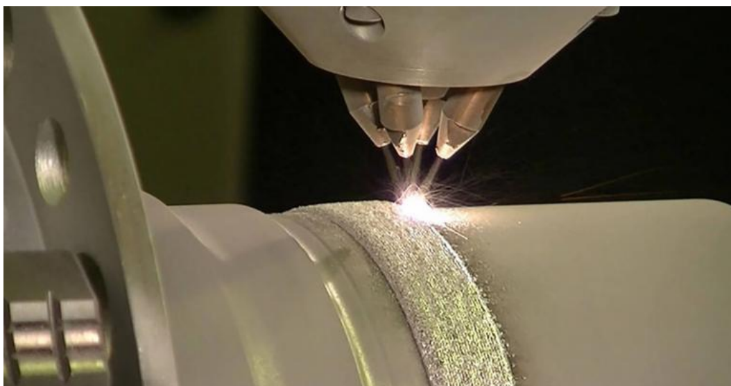
Figura 2.24 – Técnica de Directed Energy Deposition. O material é projetado à distância e solidificado instantaneamente pela emissão simultânea de energia.
