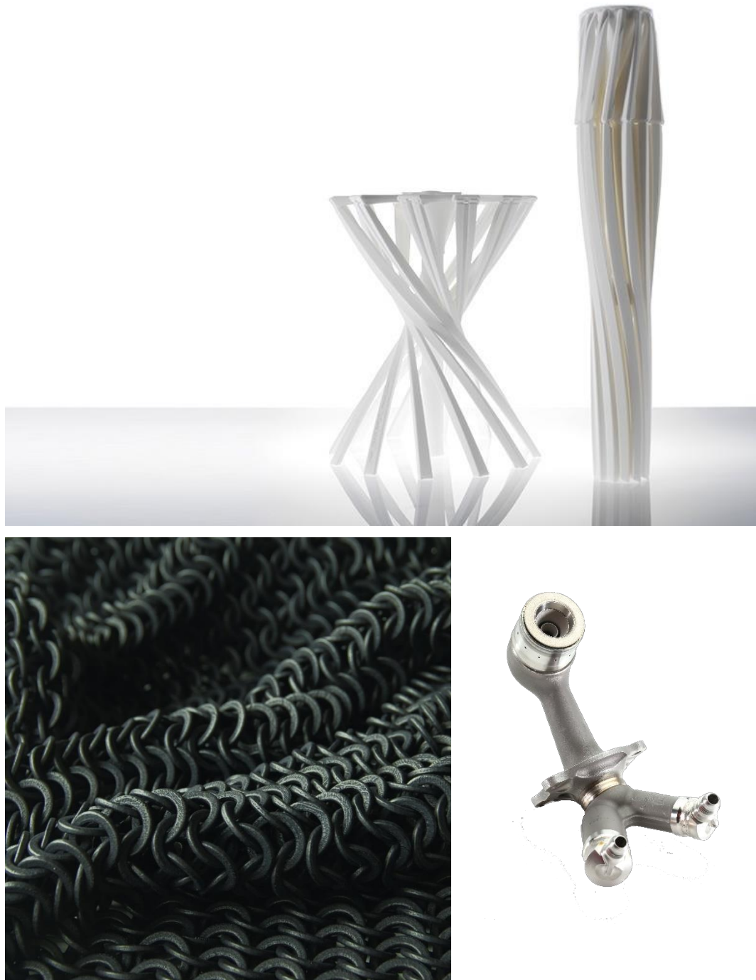
Figura 2.34 – Redução de assemblagens. Cadeira “One_Shot”, desenhada por Patrick Jouin, 2006 (em cima); Pormenor do têxtil de Jiri Evenhuis e de Janne Kyttanen, onde é visível a interligação das peças circulares (em baixo, esquerda); Bocal de combustível desenvolvido pela General Electric (em baixo, direita).
