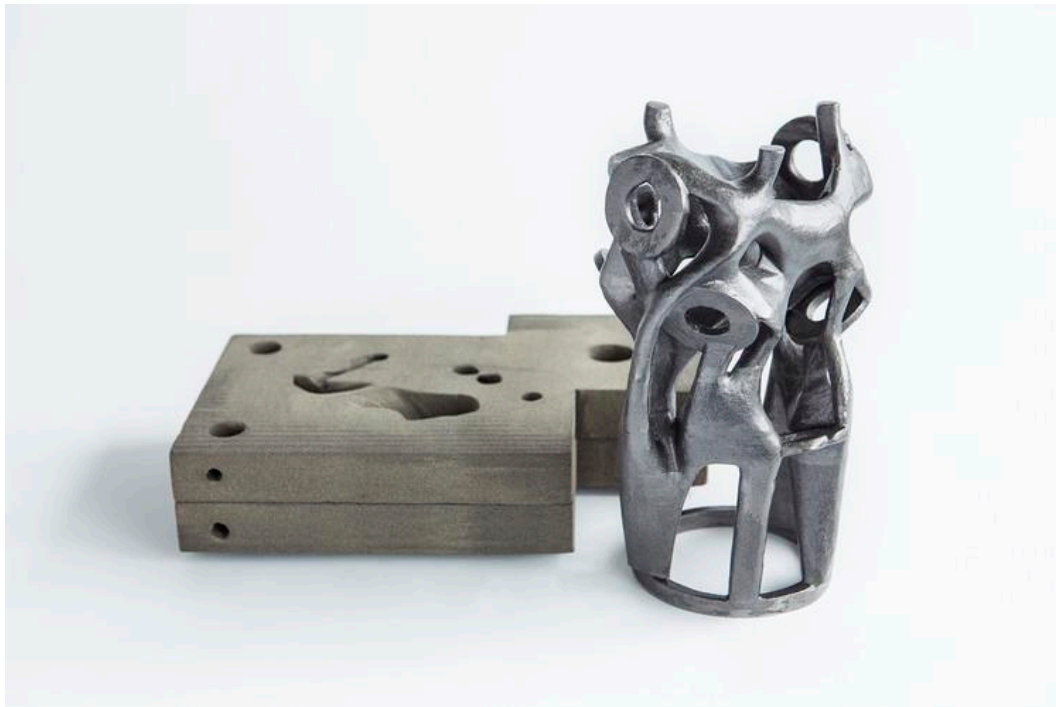
Figura 4.19 – Moldes em areia, produzidos por FA, para produzir as juntas otimizadas por fundição em metal.
