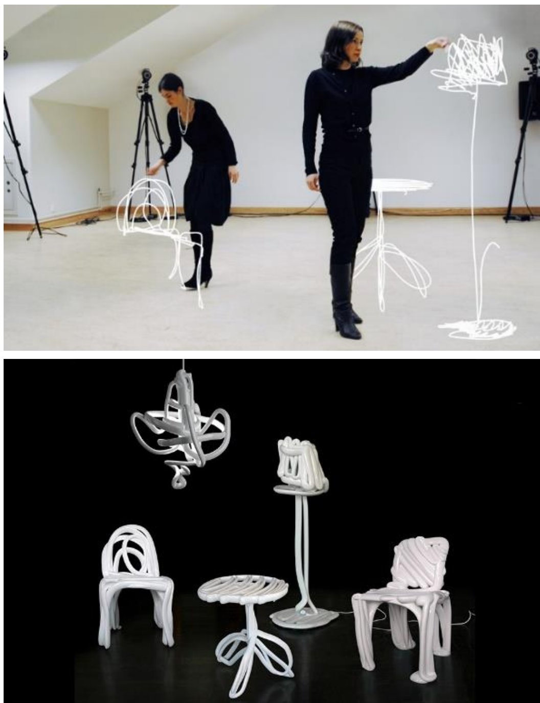
Figura 2.30 – “Sketch Furniture”, do Front, 2005. O processo de desenho espacial, através de tecnologias digitais de captação de movimento (em cima); Objetos finais, produzidos por SLA (em baixo).
