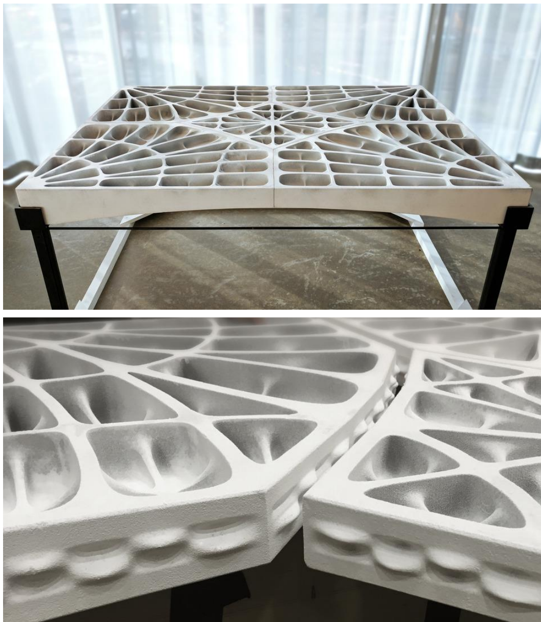
Figura 4.22 – Conjunto da laje. Protótipo, com cinco componentes, apoiado em quatro pontos (em cima); Junta macho-fêmea, sem ligação mecânica ou argamassas, entre os vários elementos.
