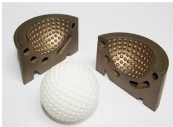
Figura 2.26 – Produção de moldes por processos de FA para utilização noutros processos de produção. Camaras de arrefecimento no interior do molde na produção de bolas de golfe.
