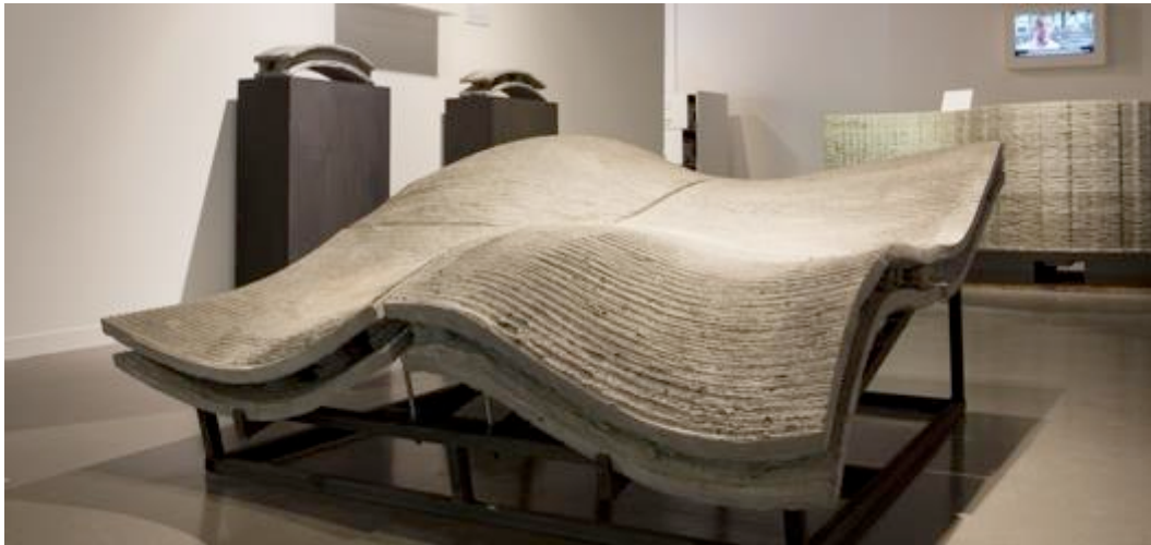
Figura 3.17 – Painel, com dupla curvatura, fabricado pelo sistema “Freeform Construction”.
