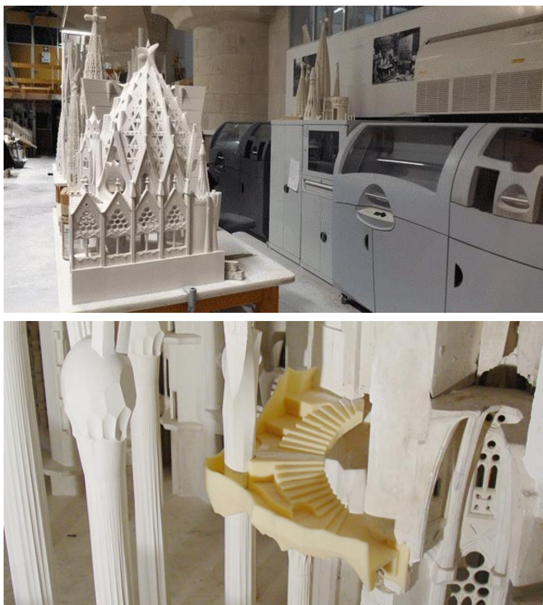
Figura 4.3 – Maquetes produzidas na oficina da Sagrada Família em Barcelona. As duas máquinas de FA que produzem as maquetes em gesso (em cima); Pormenor de uma hipótese para uma escadaria (em baixo).
