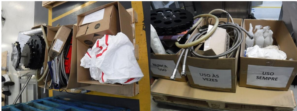
Figura 4.1 - Segregação dos materiais em caixas
