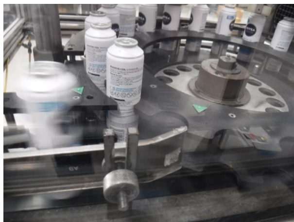
Figura 3.28 - Local de queda dos aerossóis na máquina de cravação
