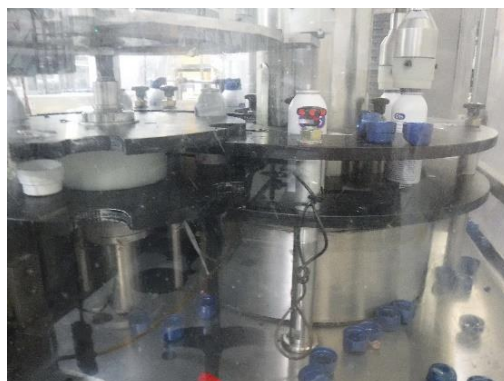
Figura 3.31 - Acumulação de tampas no local de desajuste da posição
