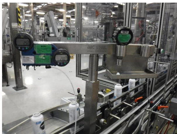
Figura 4.13 - Controlo de parâmetros de cravação junto à máquina
