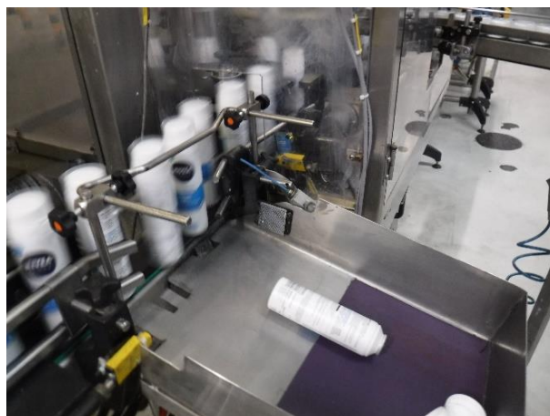
Figura 3.18 - Rejeitador de aerossóis sem tampa
