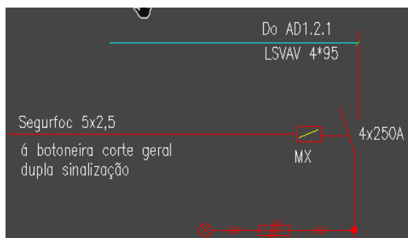
Figura 3.11: Projeto com a utilização de uma botoneira com uma bobina MX
