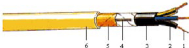
Figura 2.19: 1 alma; 2 isolamento; 3 bainha interior; 4 fios de continuidade; 5 Ecrã(blindagem); 6 bainha exterior. Imagem obtida a partir da documentação Infortiel "Condutores e cabos, parte II"
