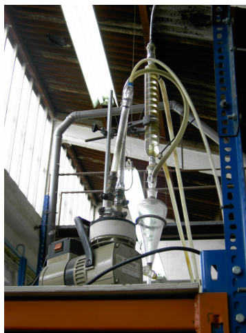
Figura 2.8 – Sistema de aspiração e de arrefecimento dos gases.
