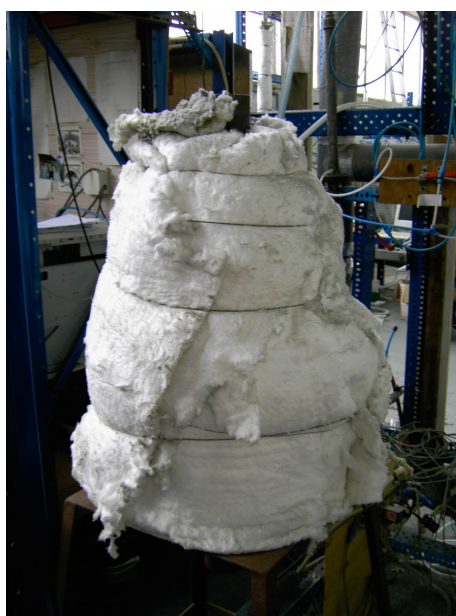
Figura 2.5 – Leito fluidizado envolto por um isolamento térmico de fibra cerâmica.
