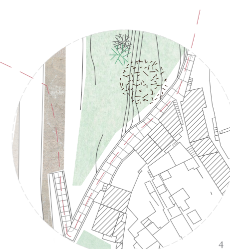
Fig. 132. Escadas que ligam duas cotas distantes - cota 23 e cota 40 - ajudando, assim, a vencer algumas barreiras topográficas que o terreno do Bairro do Aleixo enfrenta actualmente.
