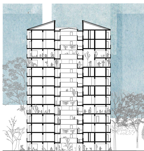
Fig. 144. Corte transversal BB' por uma das torres habitacionais propostas. No desenho é possível notar os vários pisos vazados que procuram melhorar a vida em comunidade e reforçar as relações de vizinhança.
