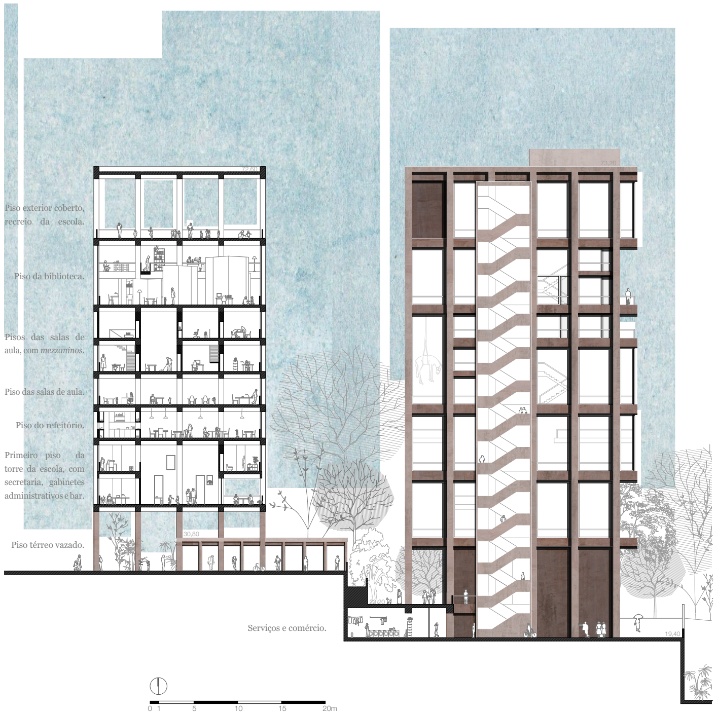
Fig. 155. Corte longitudinal CC' pela nova torre mais a Norte. Neste corte, o programa proposto é mais direccionado para a educação. Alçado Poente da nova torre mais a Sul.
